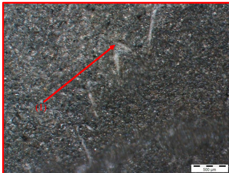
Figure III.13 : Photo lame mince B1 (lumière réfléchi) montrant un (1) : débris d'organisme
