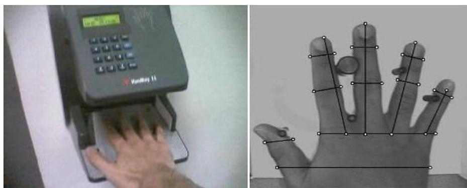
**Figure I.7:** Capteur biométrique de la géométrie de la main
