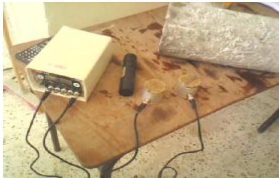
Figure III.3. Equipement de l'ultrason utilisé
