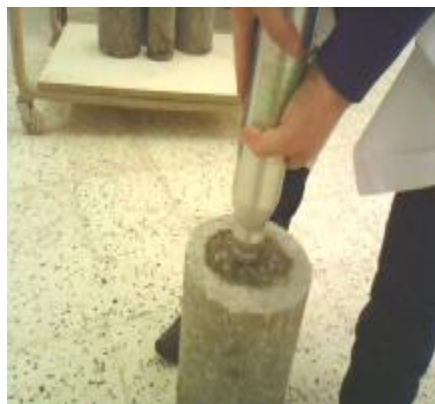
Figure I.2. utilisation du scléromètre
