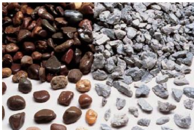
Figure II.2. Gros granulat : arrondi (gauche) et concassé (droite).
