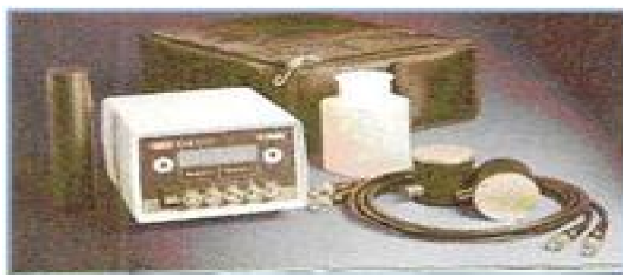
Figure I. 4. Appareil d'auscultation sonique
