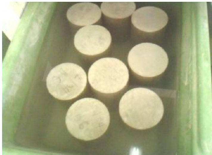
Figure III.2. Eprouvettes dans l'eau
