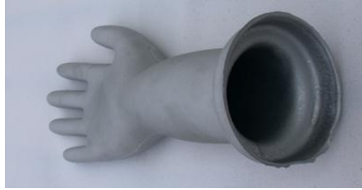
Figure I. 1. : Gant réalisé par coulée en barbotine et frittage. Outre ses bonnes propriétés thermiques et mécaniques, cette phase assure un bon mouillage puis démoulage du polymère, et résiste parfaitement aux acides utilisés
