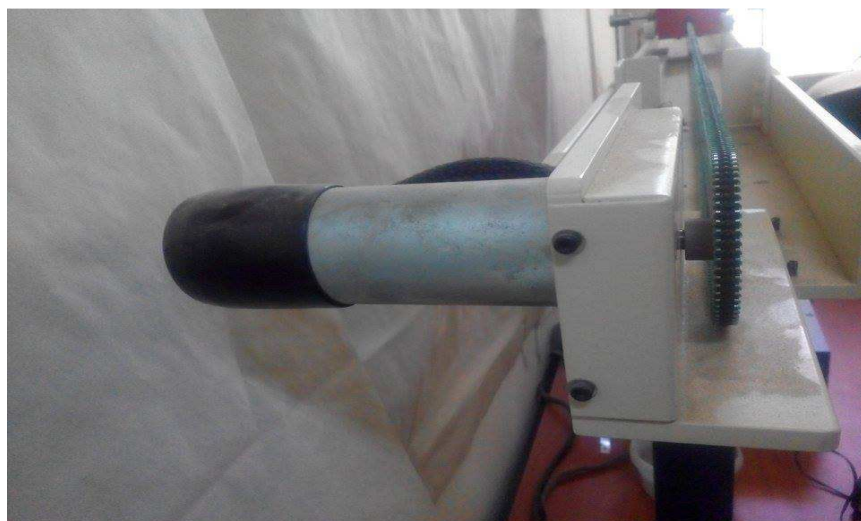
Fig. III-1 Vue de l'entraînement : moteur, courroie
