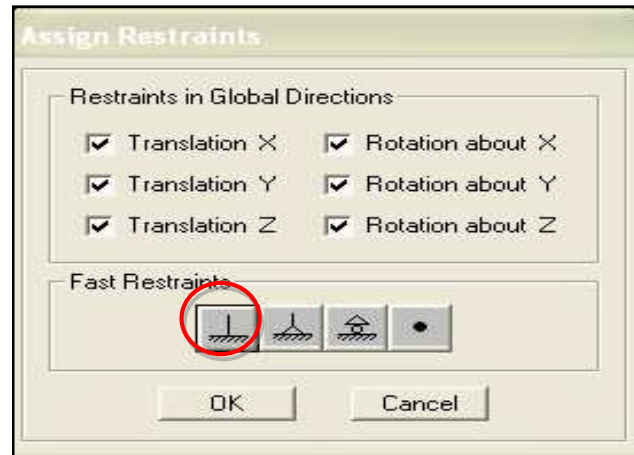
Figure 3.14 : Encastrement des poteaux.
