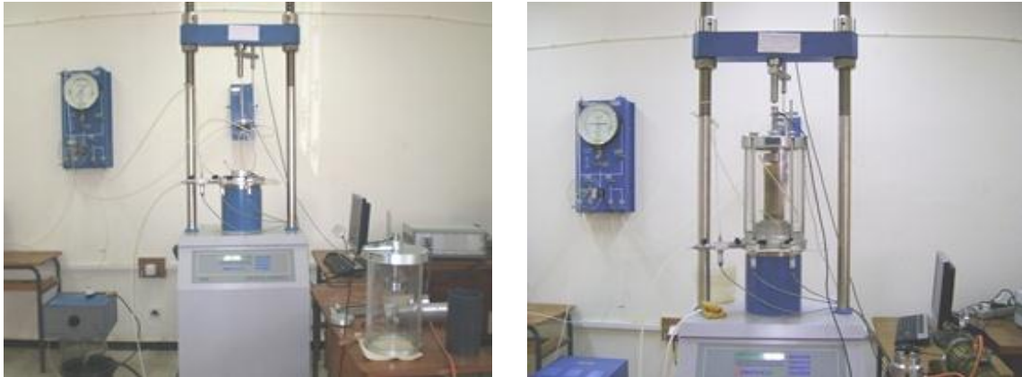
Figure III. 28 : Appareillage triaxial à chargement monotone, (ELE).
