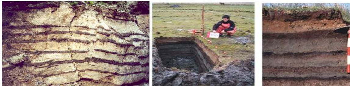
Figure I.15 : Formation d'un sol anisotrope lors du dépôt par couches, (Nguyen 2008).
