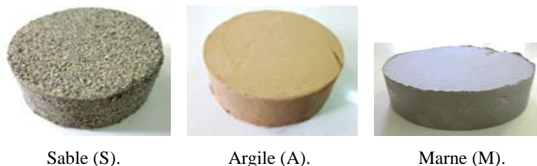
Figure III. 11 : Échantillons de sable, argile et marne, (cisaillement et œdomètre).
