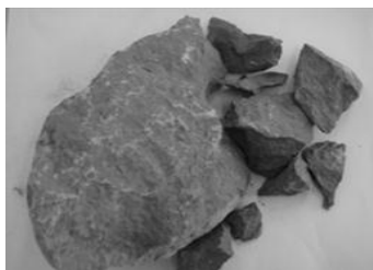
Marne en état de blocs.
