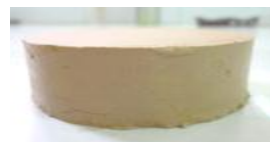
Argile + fines sableuses.
