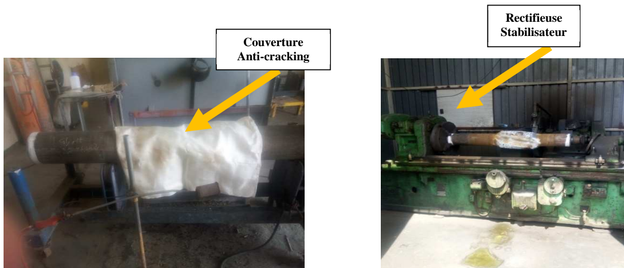
Figure V.8. Couverture anti-craque et passage du stabilisateur à la centrifugeuse [41]
