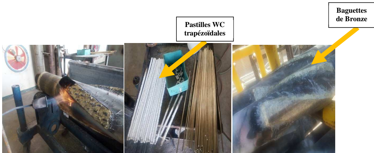
Figure V.5. : Rechargement du stabilisateur par le procédé HF 2000 [ 41]
