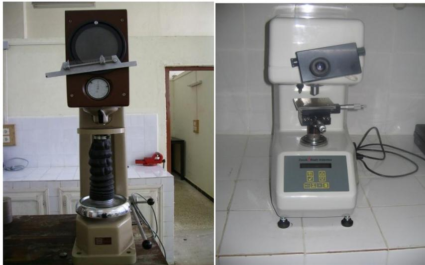
**Figure : II.12** : a) Duromètre      b) Microduromètre
