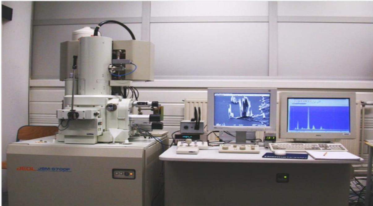
**Figure II.11:** Microscope électronique a balayage (MEB)
