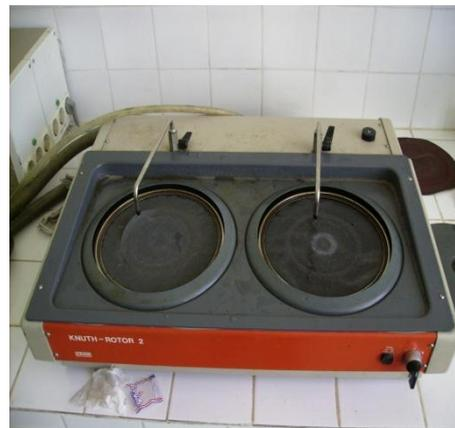
**Figure II.9:** a) polisseuse de finition
