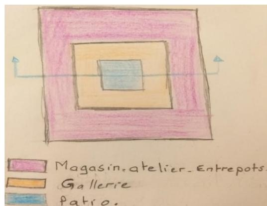
**Schéma III.4:** Plan étage d'un fondouk.
