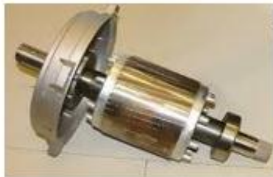
Figure I. 3 Rotor à cage d'une machine asynchrone
