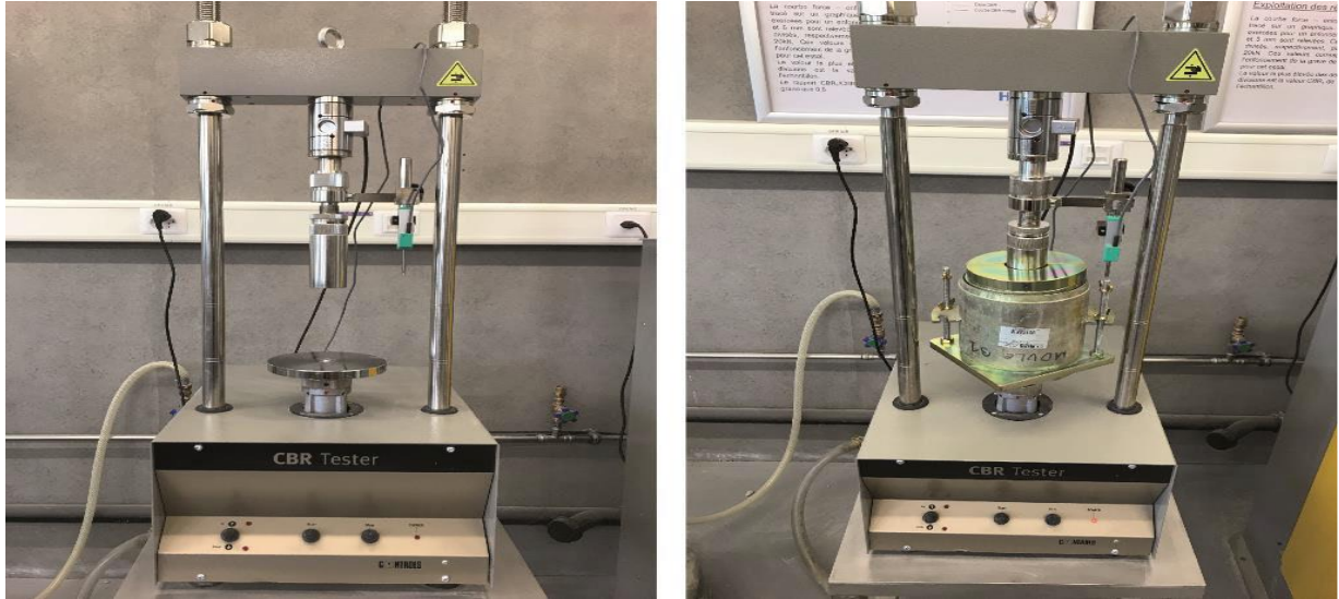
Figure III-12 :Appareillage de l'essai CBR
