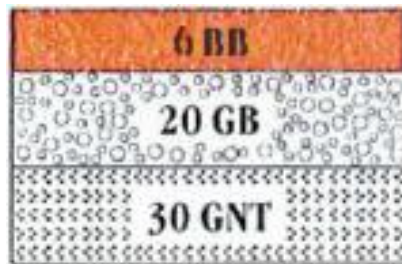
Figure IV-3 : Corps de chaussée choisi
