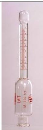
**Butyromètre à lait (Gerber)**
