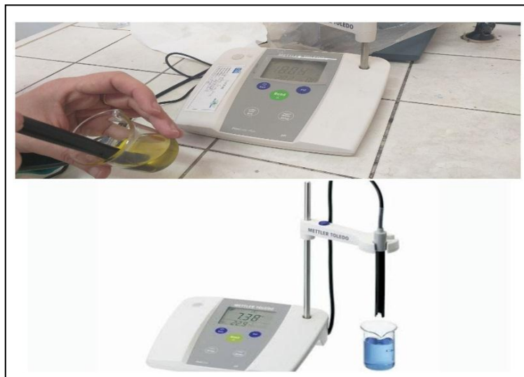
Figure 54 : La mesure du pH de la phase huileuse à l'aide de pH-mètre (METTLER TOLEDO FE20) (Zonaflona ; 2020).
