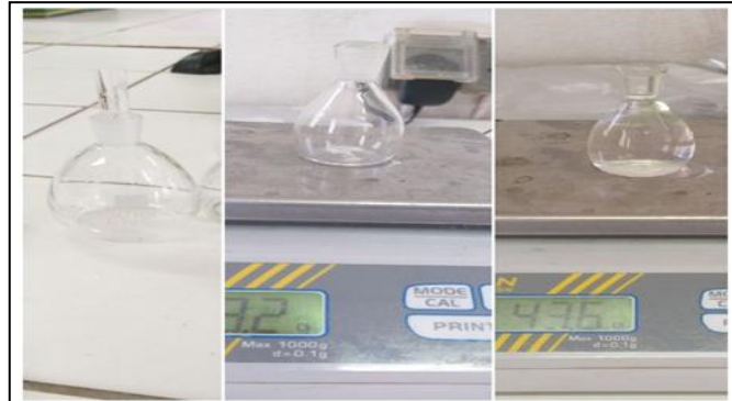
Figure 52 : Détermination de la densité relative à l'aide d'un pycnomètre (50ml) (Zonaflona ; 2020).
