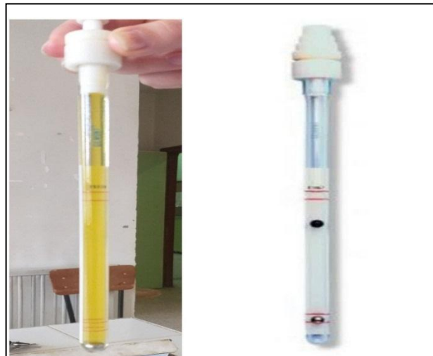
Figure 53 : Détermination de la viscosité de l'huile d'olive à l'aide d'un viscosimètre à chute de bille (cole parmer STYLO tm VISCOSIMETRE 20-1000 CP) (Zonaflona ; 2020).
