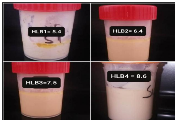
Figure 64 : Une séparation de phase observée pour les émulsions à HLB_m inférieur à 7.5 après quelques heures de leur préparation (Zonaflona ; 2020).
