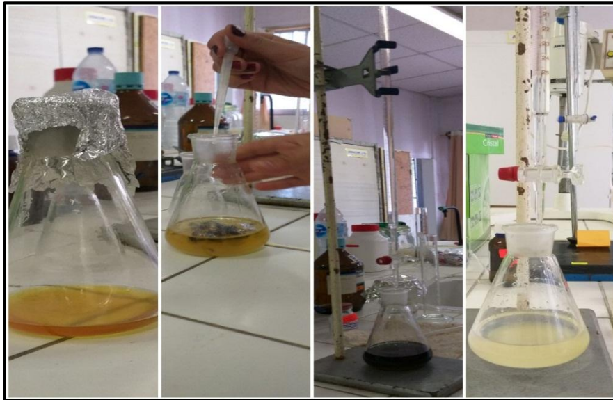
Figure 55 : Détermination de l'indice de peroxyde de l'huile d'olive (Zonaflona ; 2020).
