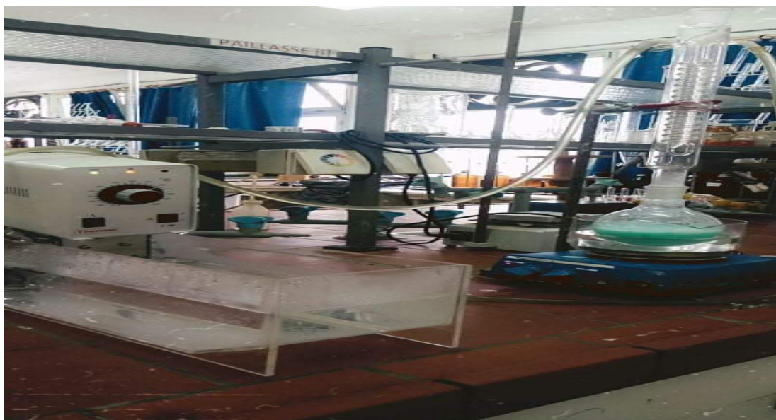
Figure III.2. Montage du Chauffage sous reflux.
