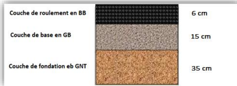
Figure IV-8: Structure de notre chaussée d'après CTTp.
