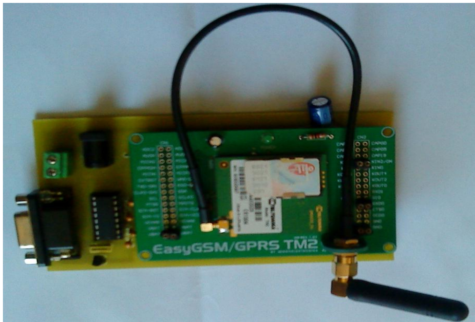
Figure IV.12 : Photo de carte d'interface GSM
