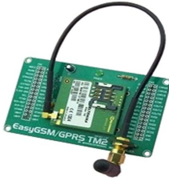
Figure IV.13 : La platine d'adaptation du module GSM TM2
