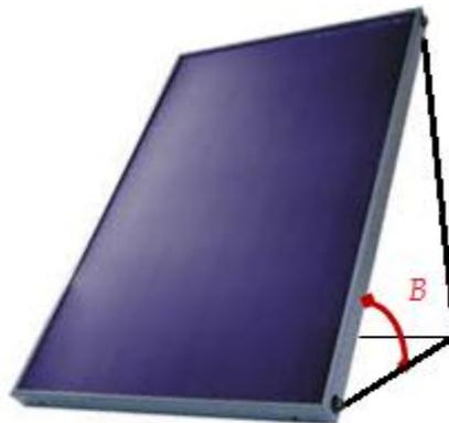
**Figure (II-4)** : schéma qui montre l'angle d'inclinaison dans un capteur thermique
