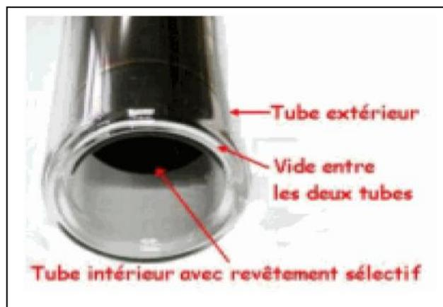
Figure (II.12) : schéma d'un capteur à tube sous vide à effet thermos.
