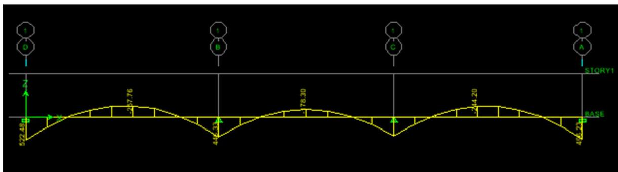
**Figure VIII.2 :** diagramme des moments de la poutre de rigidité à l'ELU
