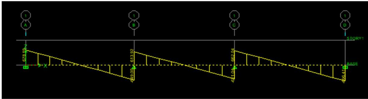
Figure VII.3 : diagramme des efforts tronçon de la poutre de rigidité à L'ELU
