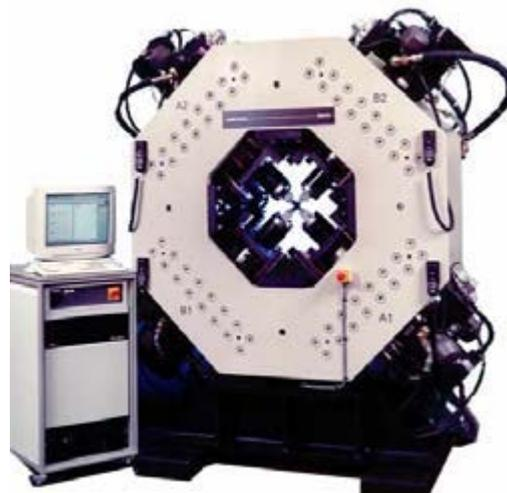
*Figure I.28: Système de traction biaxiale, [23]*
