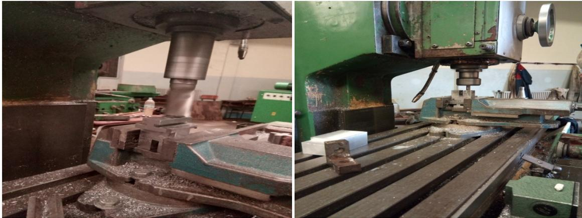
*Figure II.15 : usinage de bride*
