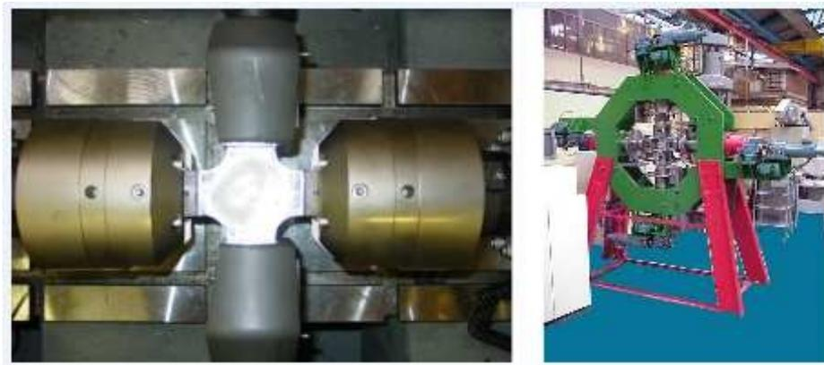
*Figure I.25 : image de gauche : éprouvette de traction biaxiale montée .image de droite : dispositif de traction biaxial de laboratoire 3s à Grenoble.*
