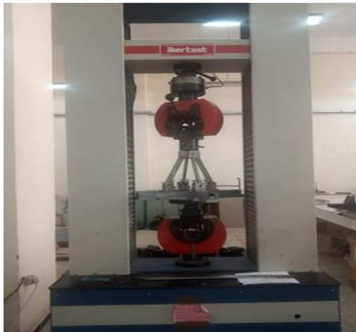
*Figure II.13 : fixation de l'appareil sur la machine de traction.*
