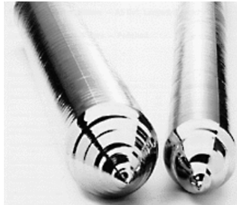
FIGURE 1.6 – Lingots de silicium monocristallin obtenus par la méthode de Czochralski : celui de gauche a un diamètre de 200 mm et celui de droite un diamètre de 150 mm [10].
