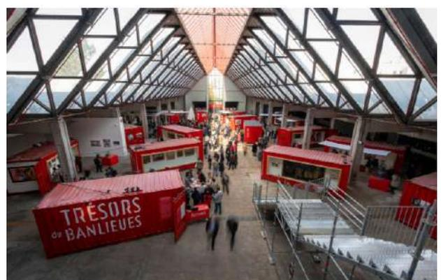
**FigureIII.49** : des poutres métalliques triangulées, reliées par des sheds vitrés, intègrent une verrière centrale /Source : [www.telerama.fr/sortir/chagall,-calder-et-caillebotte-sexposent-a-genevilliers,n6483509.php](http://www.telerama.fr/sortir/chagall,-calder-et-caillebotte-sexposent-a-genevilliers,n6483509.php)
