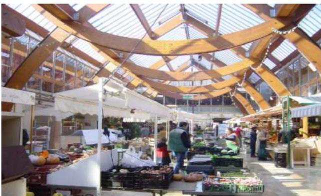
**FigureIII.48** : la charpente en lamellé- collé à verrières dans le hall de Quimper
