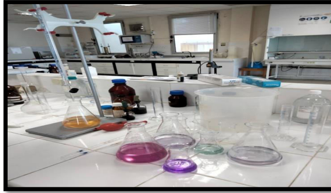
Figure IV.4: Dosage de la dureté totale TH.
