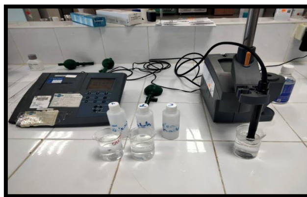
Figure IV.2. pH-mètre de type WTW pH 730.
