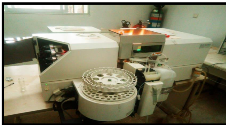
Figure III.26: Appareil de la spectrométrie d'absorption atomique à flamme.
