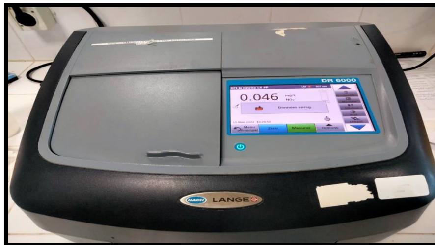
Figure III.24: Spectrophotomètre UV-Visible DR 6000.
