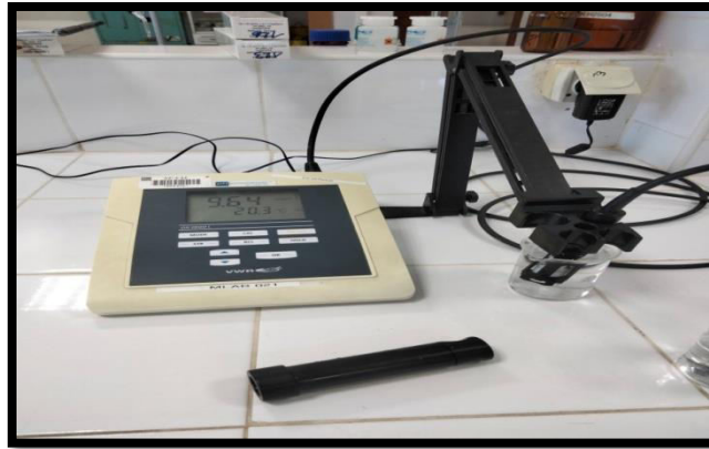
Figure IV.7: Appareil, Oxymètre OX 4000L.
