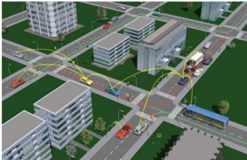
Figure 2. Exemple de réseau VANET ( www.car-2-car.org )
