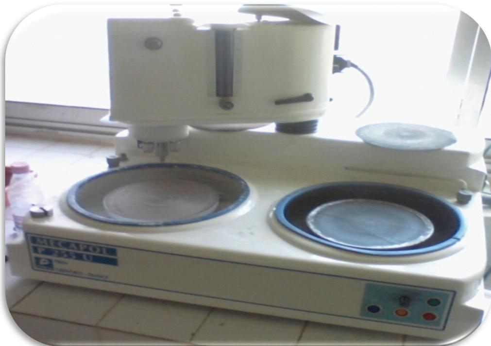
**Fig.8.** Polisseuse utilisée de marque MECAPOL.
