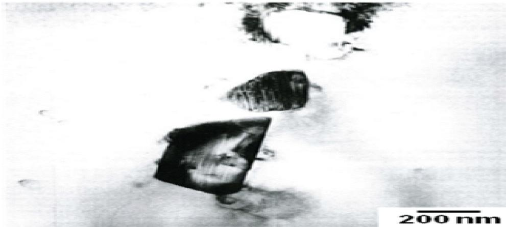
**Fig 8.** microstructure de précipite de  $Zr (Cr, Fe)_2$  [21]
