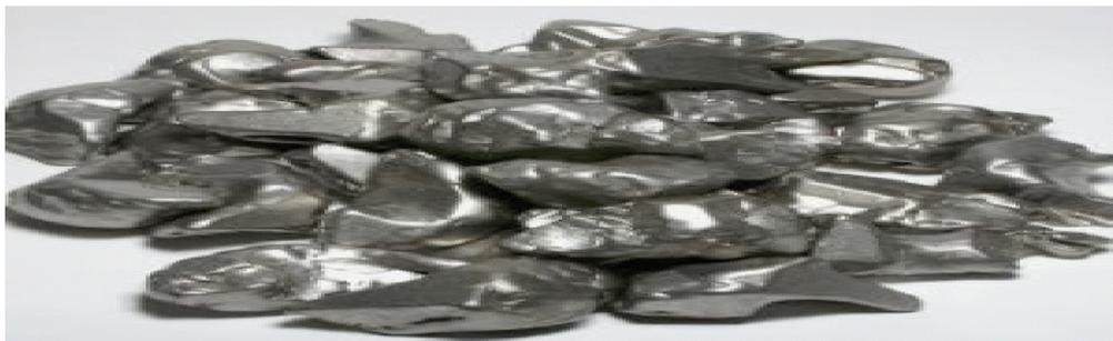
Fig.4. Zirconium pur sous forme d'éponge.
