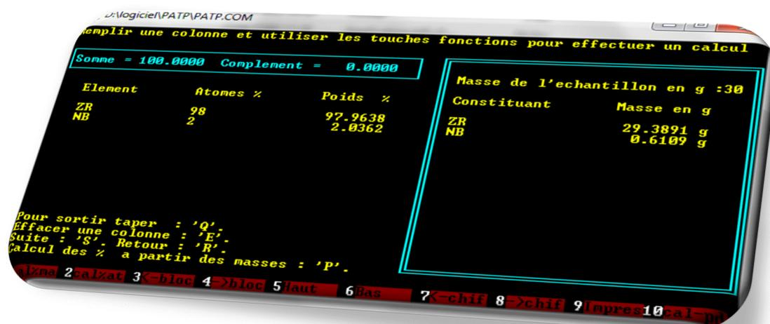
*Fig.3. présentation d'un exemple de calcul par le logiciel PATP de (90%Zr, 10%Nb) à une masse totale de 30 grammes.*
