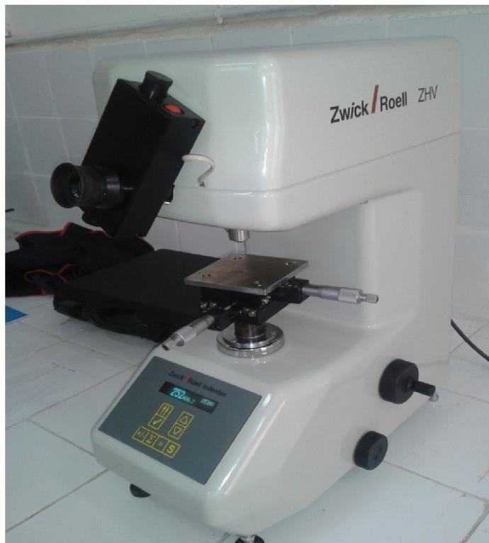
*Fig.11. machine de microdureté de marque Zwick/Roell.*
