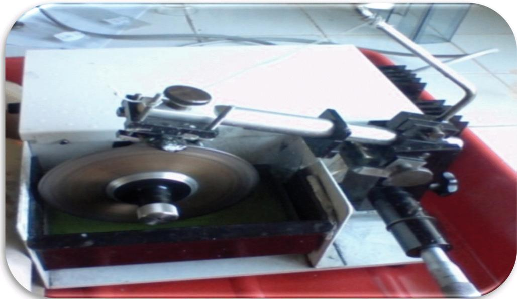
*Fig. 6. Micro-tronçonneuse utilisée de marque MECATOME.*
