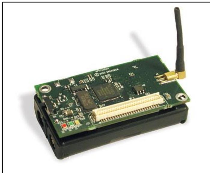
Figure I.1 : capteur MicaZ
