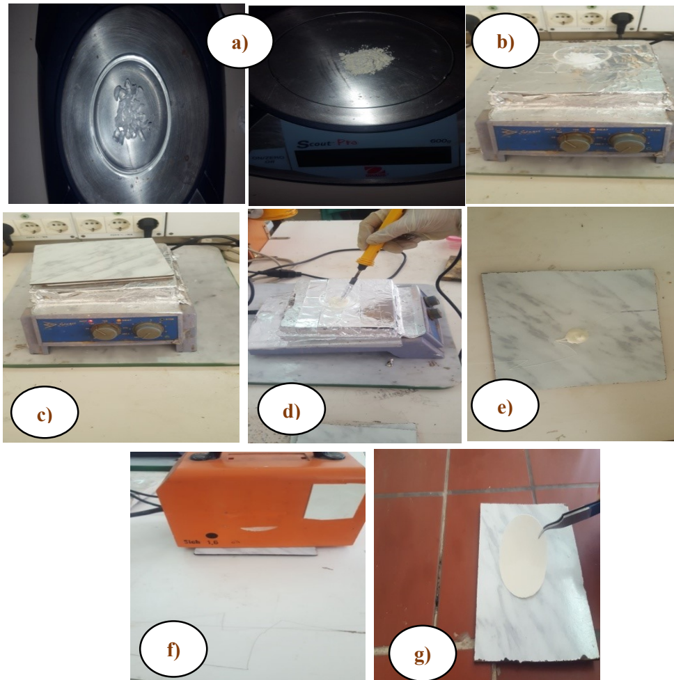
Figure II. 4: Différentes étapes d'élaboration des composites silicone/NBT-BT
