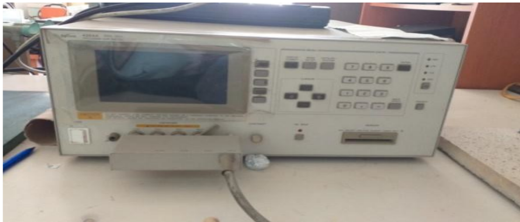
Figure II. 9: Photographie Impédancemètre HP 4284A
