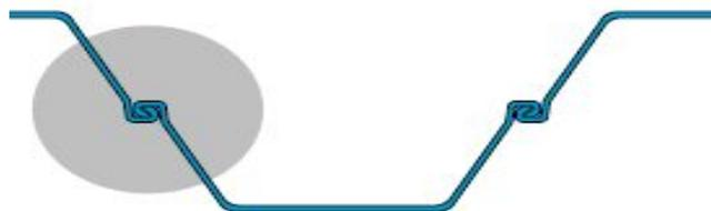
Fig. II.59. Etanchement avec combinaison bentonite ciment.
