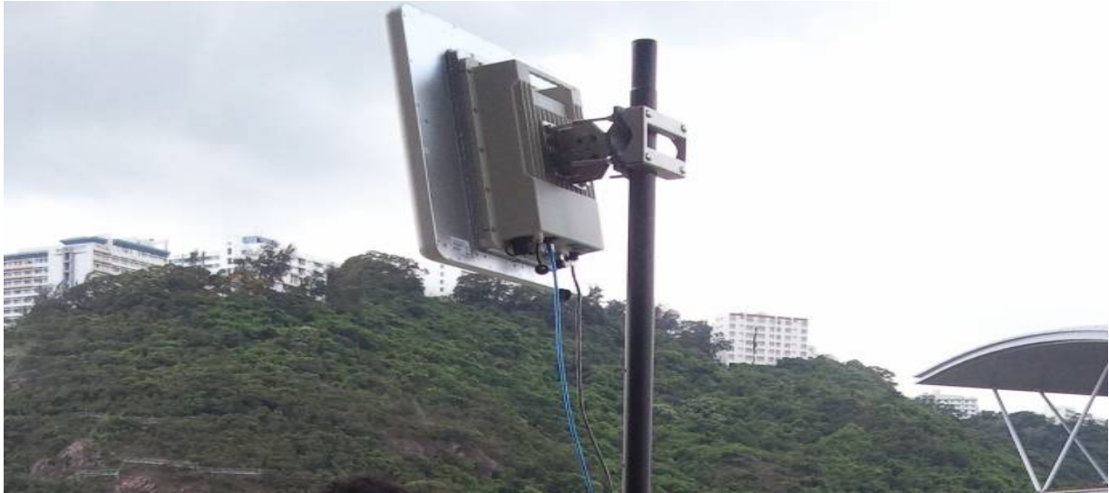
Figure 27 : A8-Ein installation typique.
