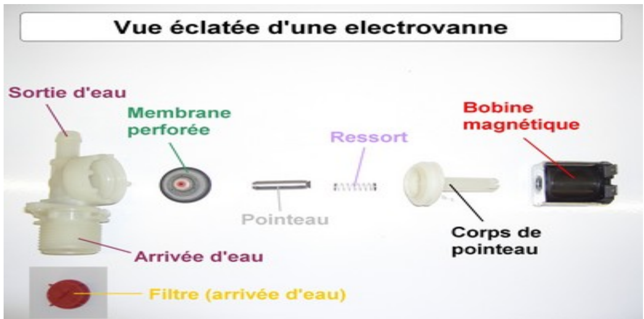
Fig II- 13: Vue éclatée d'une électrovanne
