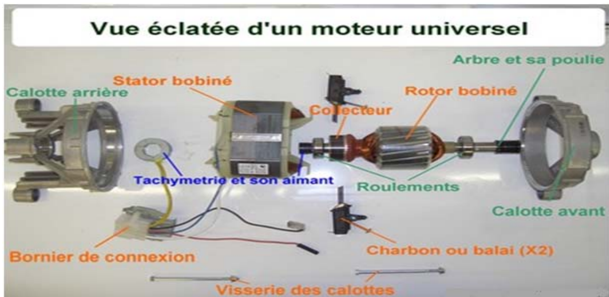
Fig II-25 : Vue éclatée d'un moteur universel
