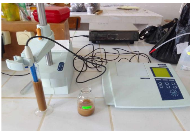
Figure 19 : Illustration de la mesure du pH de la solution du sol
