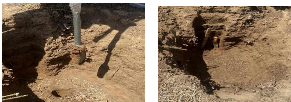
Figure 16 :A/ Prélèvement avec la tarière B/Profil pédologique
