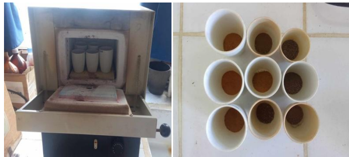
Figure 21 : Illustration de la mesure de la matière organique :
