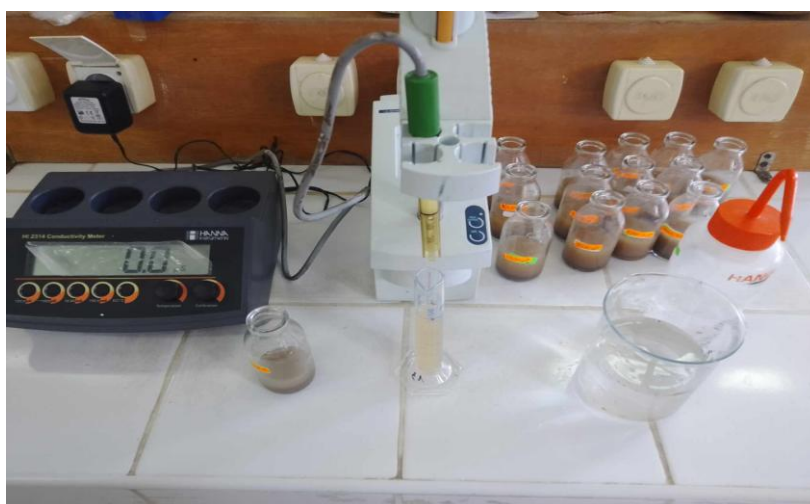
Figure 20 : Illustration de la mesure de la CE de la solution du sol
