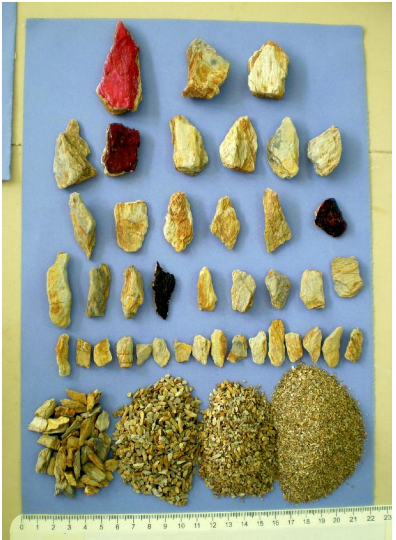
*Figure VII-2 : Étalage des échantillons du schiste de différents diamètres après identification*
