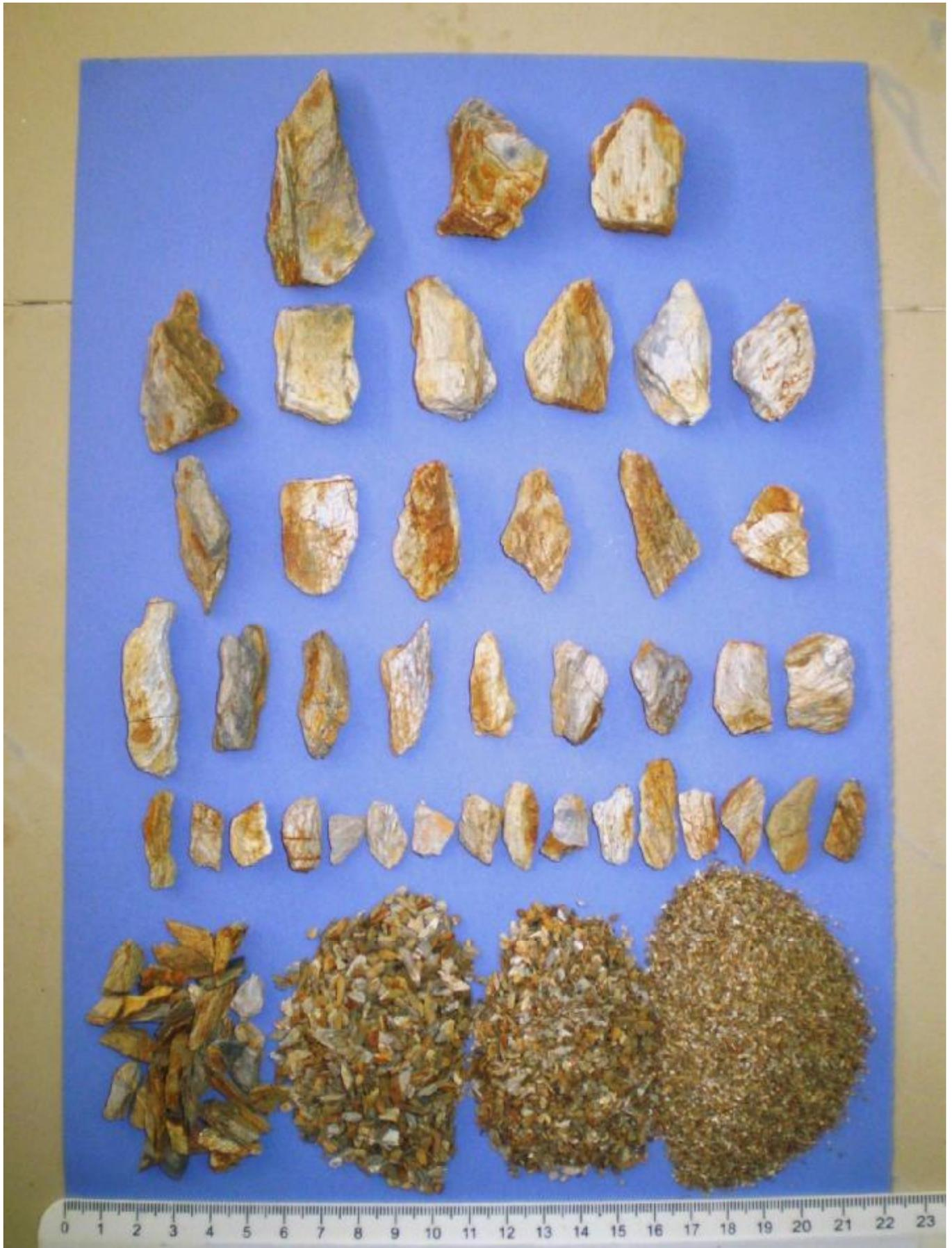
*Figure VII-1 : Étalage des échantillons du schiste de différents diamètres avant identification*
