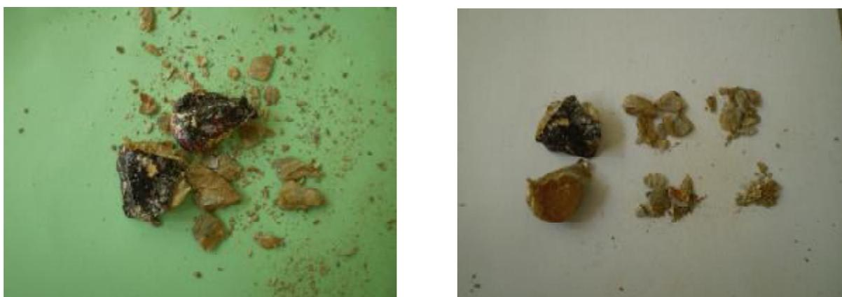
**Figure VII-29** : Échantillon N°3 du schiste après écrasement a l'essai oedométrique
