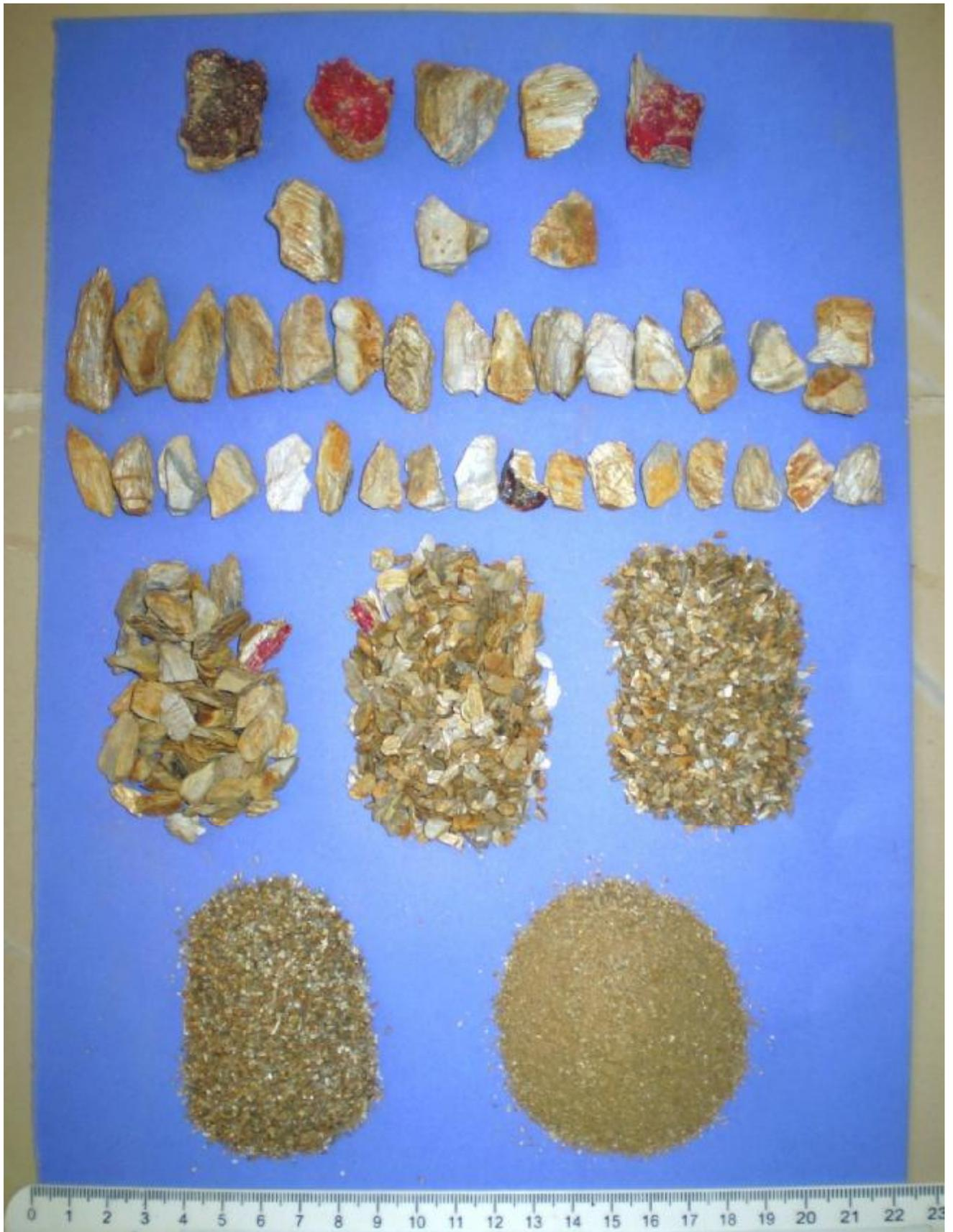
**Figure VII-39 : Étalage des échantillons du schiste de différents diamètres après essai d'écrasement à l'oedomètre**
