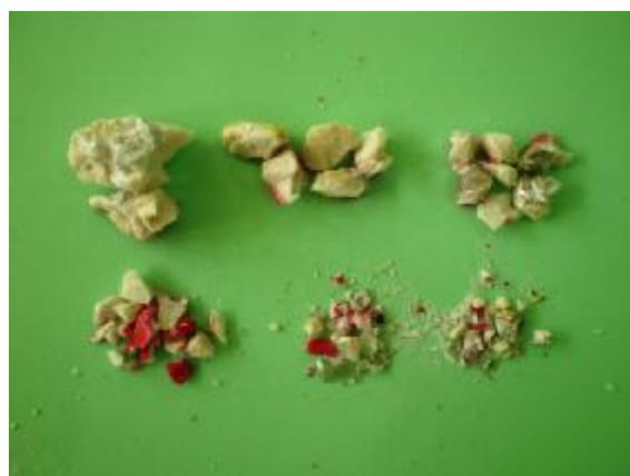
***Figure VII-95** : Échantillon N° 1 du granite après écrasement
