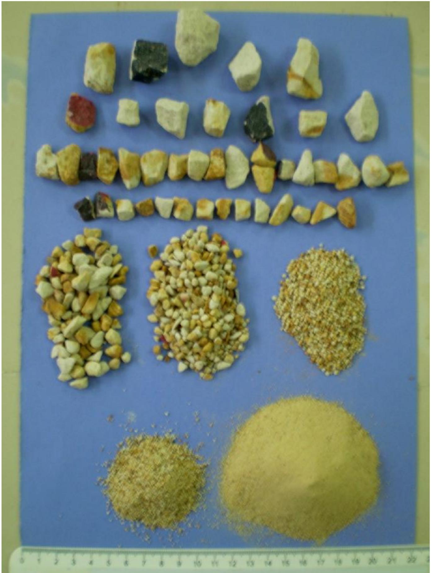
*Figure VII-82 : Étalage des échantillons du schiste de différents diamètres après écrasement*
