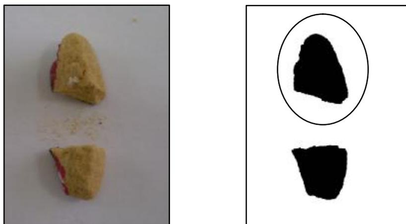
***Figure VII-76 : Échantillon N° 4 du grés Après écrasement
