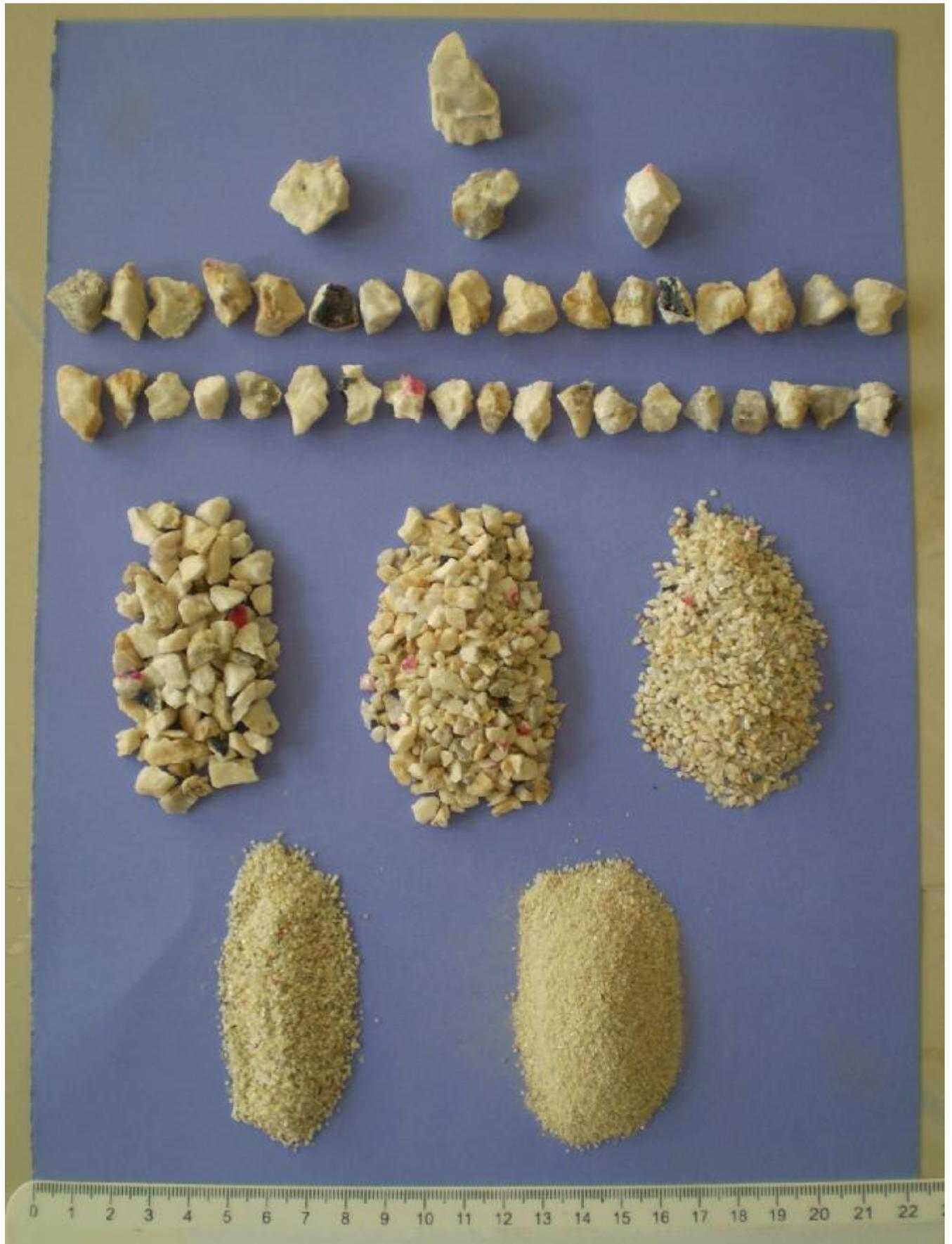
**Figure VII-117: Étalage des échantillons du Granite après essai d'écrasement à l'oedomètre**
