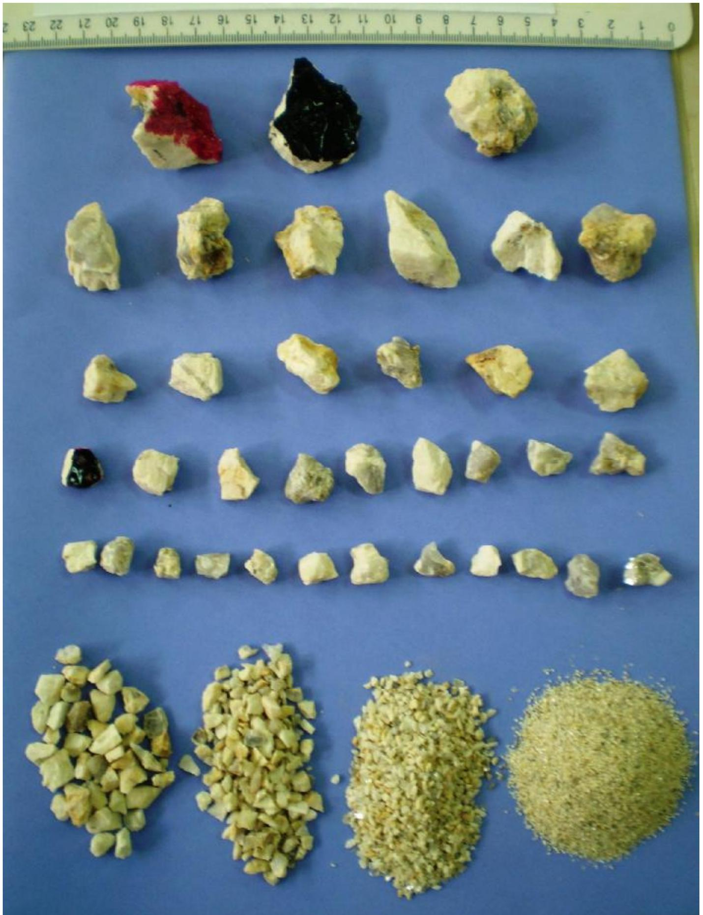
*Figure VII-86 : Étalage des échantillons du granite de différents diamètres après identification*
