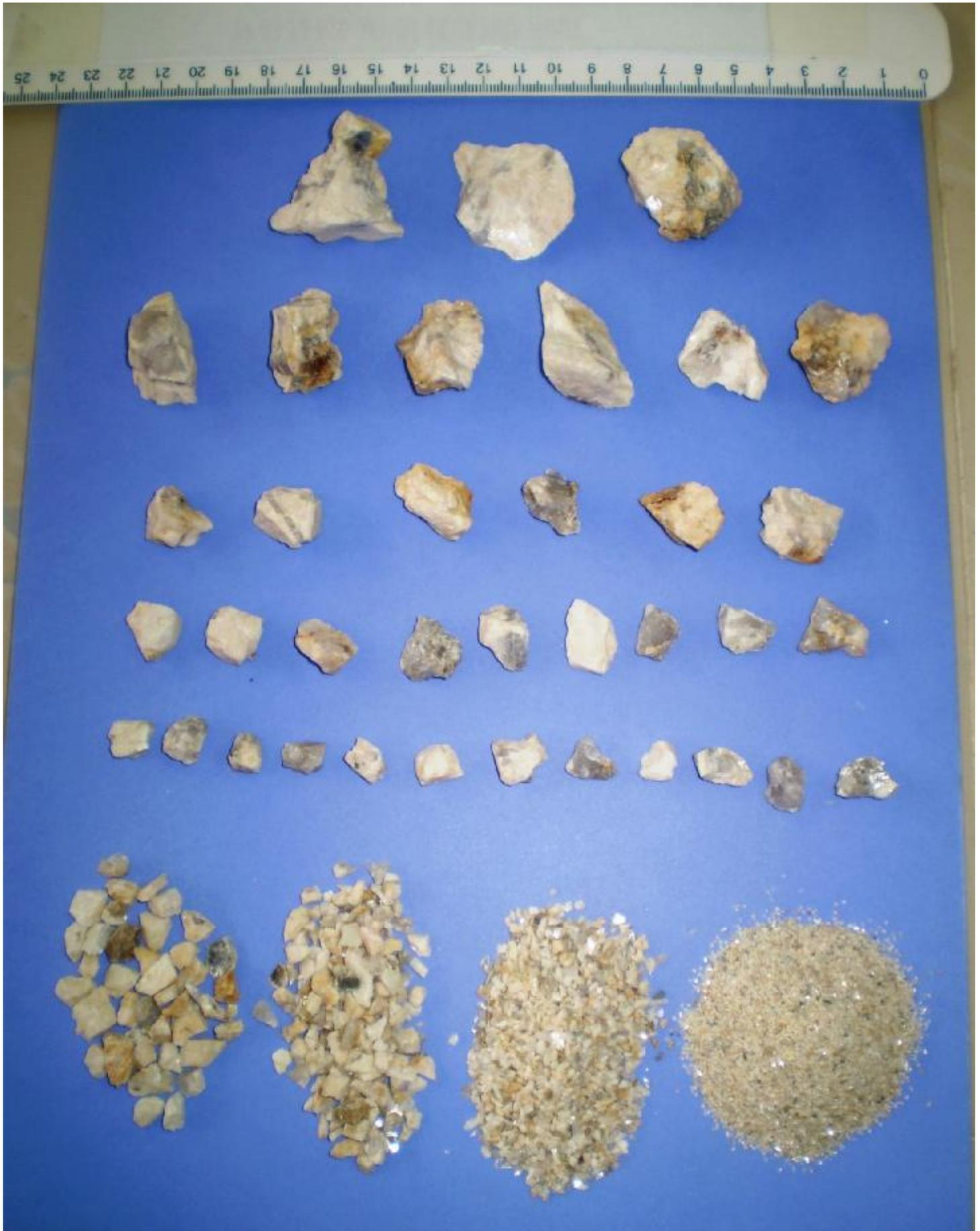
*Figure VII-85 : Étalage des échantillons du granite de différents diamètres Avant identification*
