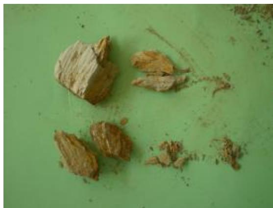
***Figure VII-23 : Échantillon N°2 du schiste après écrasement a l'essai oedométrique
