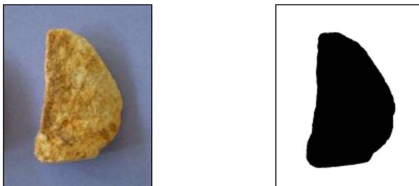
***Figure VII-63 : Échantillon N° 2 du grès Avant écrasement
