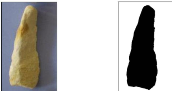
***Figure VII-69 : Échantillon N°3 du grés Avant écrasement
