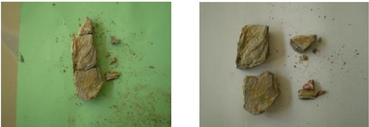
***Figure VII-11 : Échantillon N° 1 du schiste après écrasement a l'essai oedométrique
