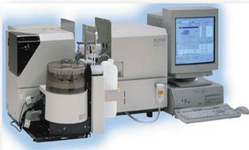
Figure III.2: Appareillage de la SAA Shimadzu AA-6800 utilisé.
