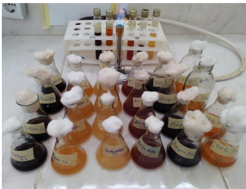
Figure 23 : Inoculation des différents milieux à base de sous-produits agricoles en vue de culture en batch sur des Erlenmeyers par les 4 souches sélectionnées.
