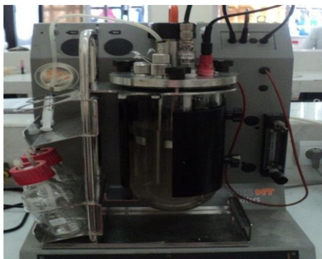
Figure 24 : Bioréacteur Minifors 2L (INFORS HT) utilisé pour la production des biosurfactants par les souches sélectionnées.
