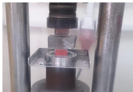
Figure 56. Essai mécanique de compression sur mortier
