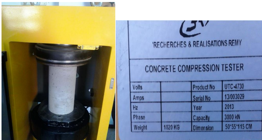
Figure 60. Essai de compression avec logiciel de commande
