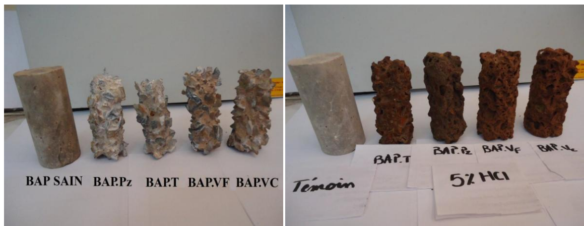
Figure 37. Dégradation des échantillons du béton après 6 semaines d'immersion dans la solution d'acide sulfurique H_2SO_4 et d'acide chlorhydrique Hcl.[47]
