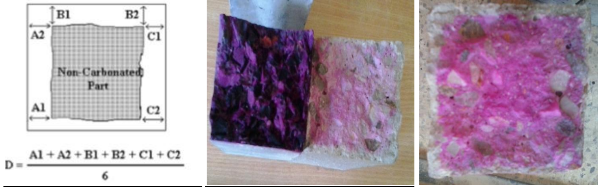
Figure 71. Principe de la profondeur de dégradation
