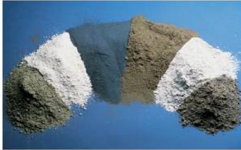
Figure 11. Ajouts cimentaires. De gauche à droite : cendres volantes (classe C), métakaolin (argile calcinée), fumée de silice, cendres volantes (classe F), laitier et schiste calciné [9].
