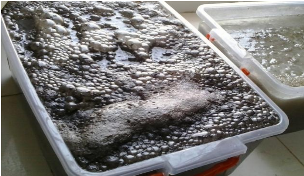
Figure 68. La réaction chimique lors d'immersion des éprouvettes de béton et mortier dans la solution acide Hcl.
