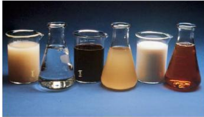
Figure 14. Adjuvants liquides de gauche à droite : agent anti-lessivage, réducteur de retrait, réducteur d'eau, agent moussant, inhibiteur de corrosion et agent entraîneur d'air [9].
