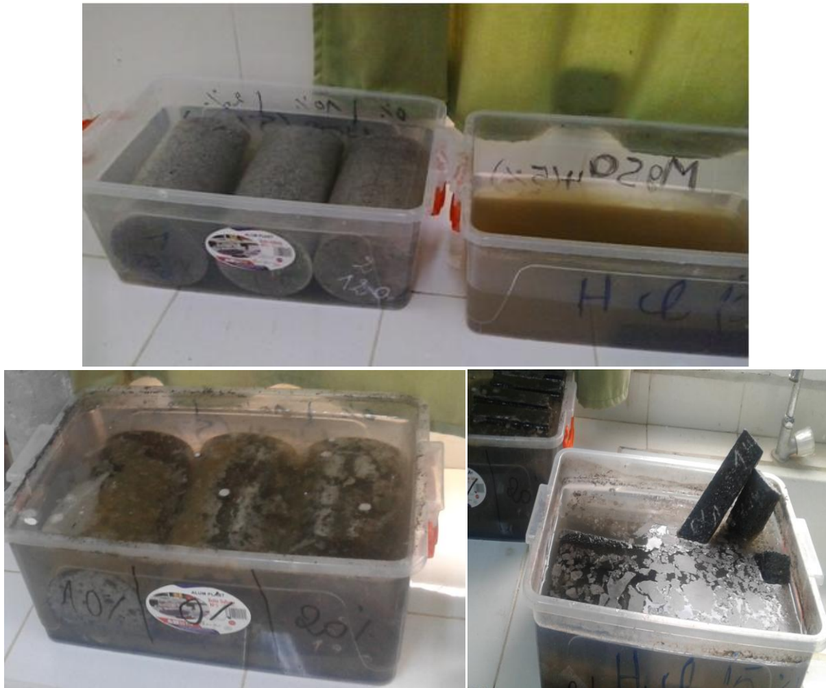
Figure 67. Acide Hcl sous forme liquide et le MgSO_4 sous forme solide
