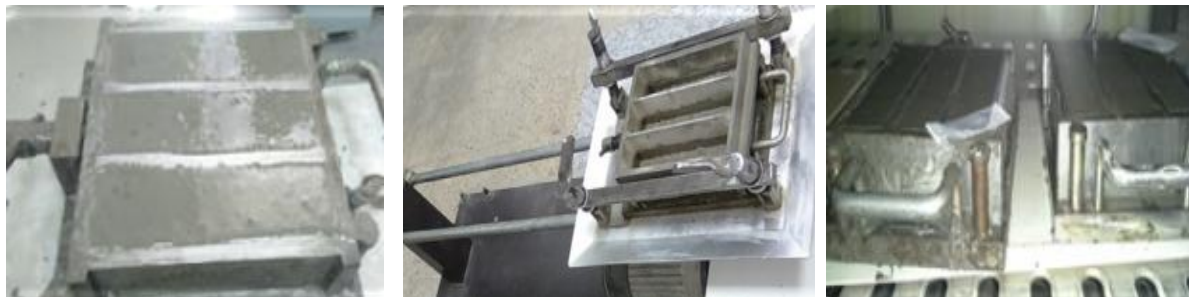
Figure 54. Confection d'éprouvettes de mortier, appareil à choc et chambre de conservation.
