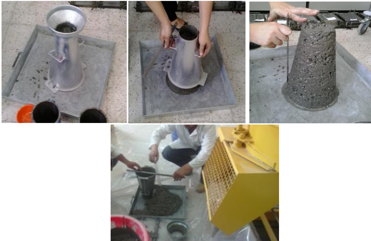
Figure 59. Essai d'affaissement au cône d'Abrams réalisé au
