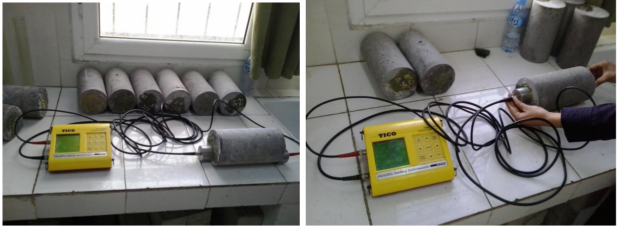
Figure 62. Mesure de vitesse de propagation des ondes ultrasonique.
