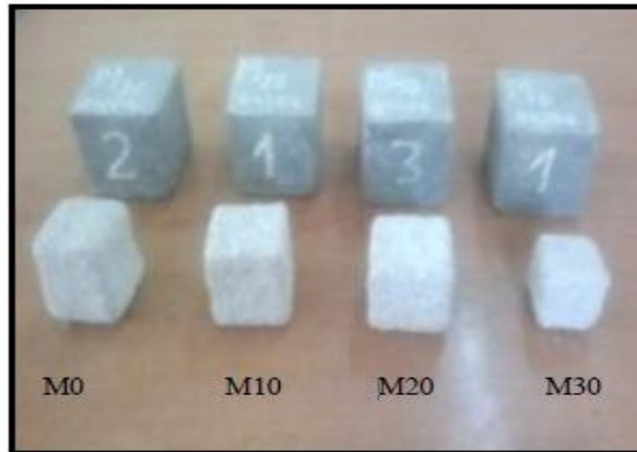
Figure 35. Etat des éprouvettes après 105 jours d'immersion dans 5% H_2SO_4 [68]
