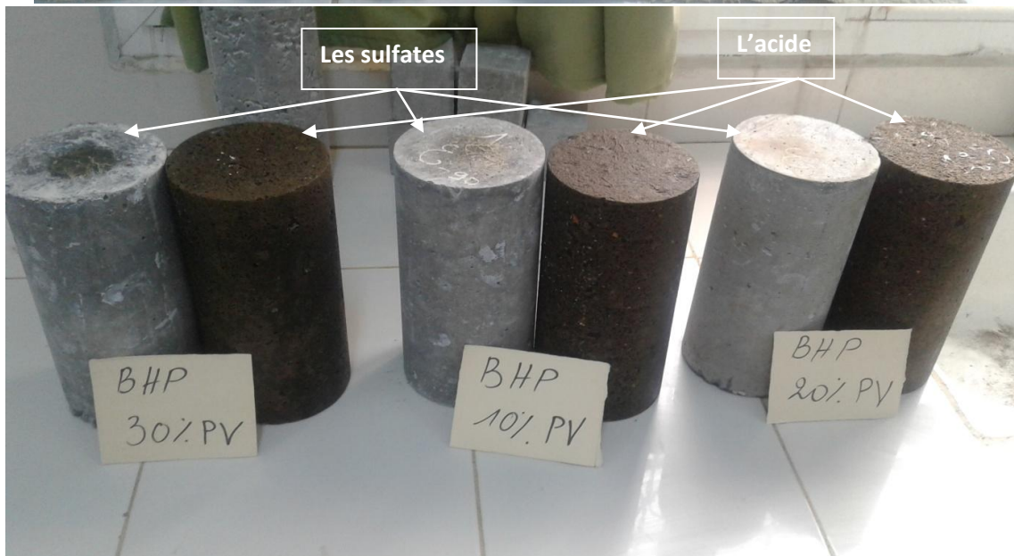
Figure 108. Aspect général des échantillons après 180 jours de réservations dans les deux solutions
