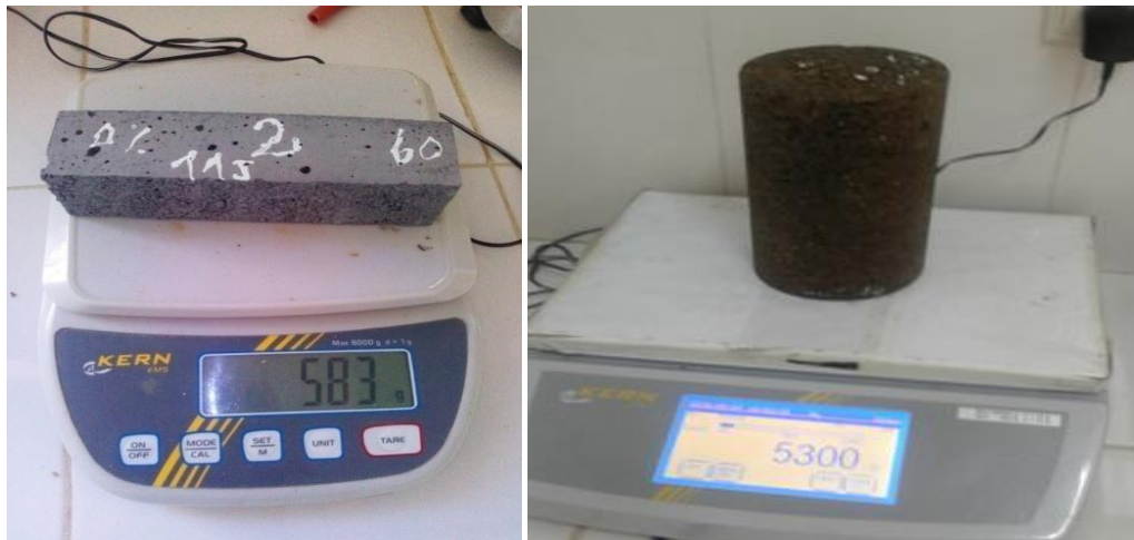
Figure 70. La prise de la masse d'échantillons avant et après immersion
