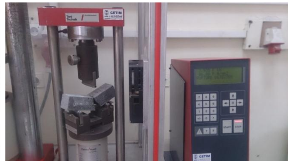
Figure 55. Essai mécanique de flexion sur mortiers
