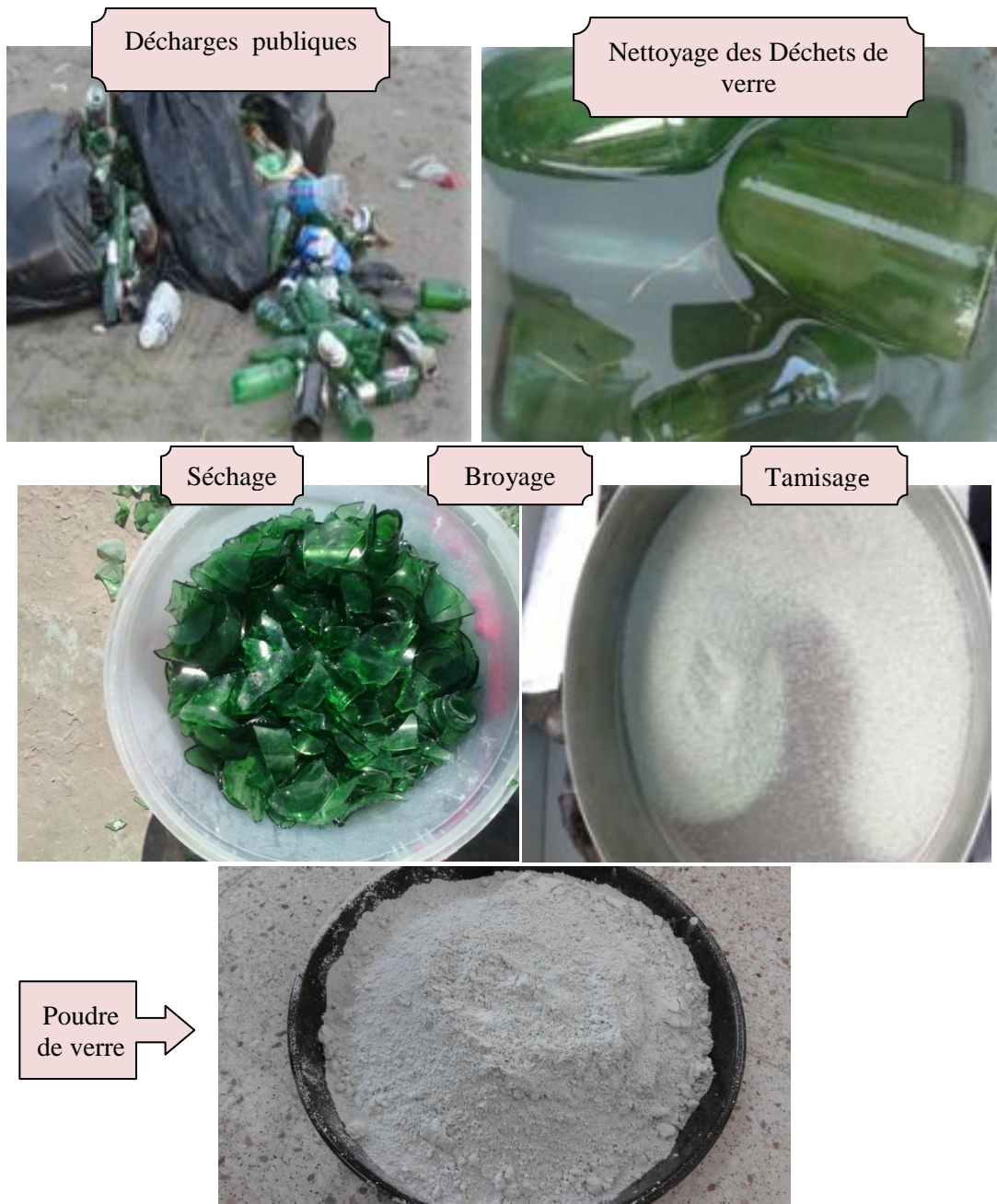
Figure 49. a Transformation des déchets de verre en poudre de verre
