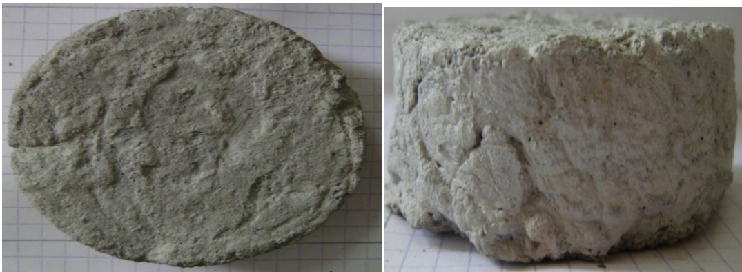
Figure V-34 : Echantillon 1 marne 1 après le 4 em cycle.
