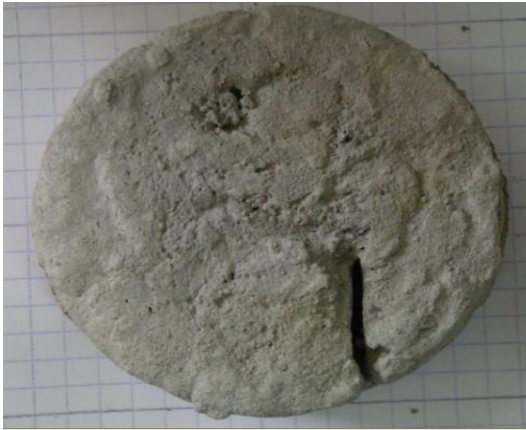
Figure V-30 : Echantillon 1 marne 1 après le 3 em cycle.
