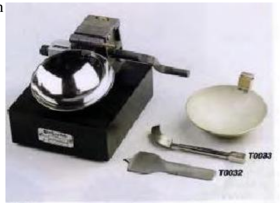
Figure IV-5: Coupelle de Casagrande.
