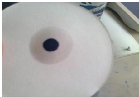
Figure IV-12 : Teste au bleu négatif.
