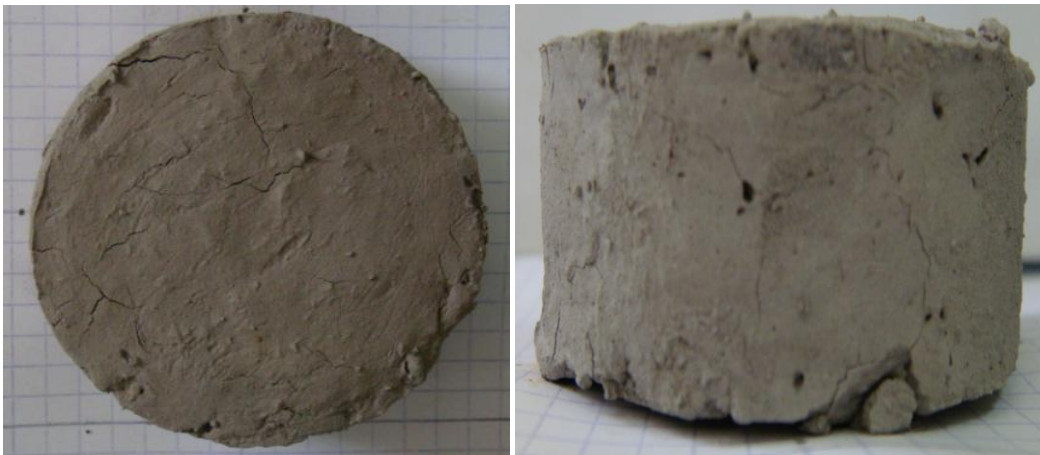
Figure V-25 : Echantillon 2 marne 2 après le 1 er cycle.
