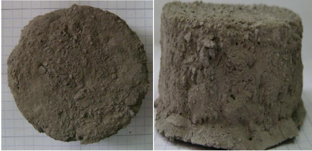
Figure V-33 : Echantillon 2 marne 2 après le 3 em cycle.
