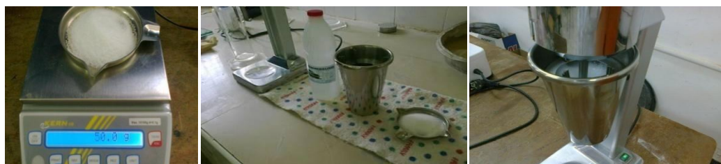
Figure IV-16 : Etapes de déroulement d'essai de sédimentométrie.
