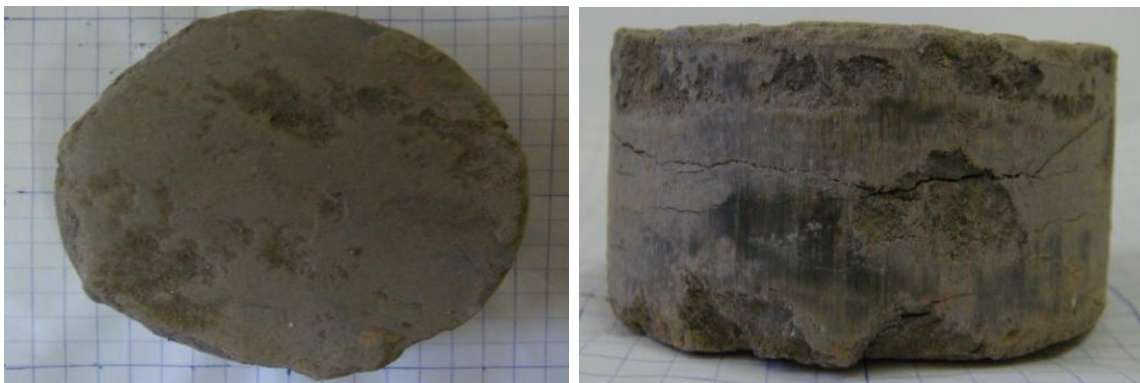
Figure V-8 : Echantillon 1 de la marne 2 après l'étuvage.
