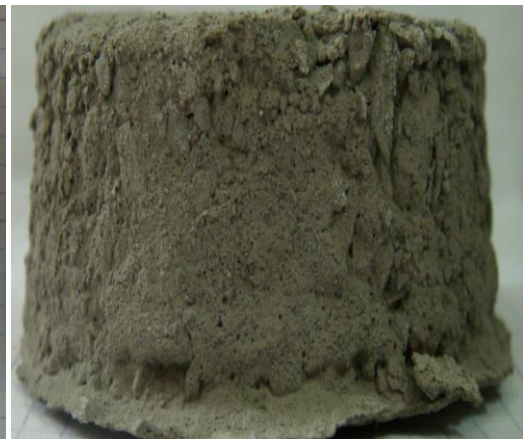
Figure V-32 : Echantillon 1 marne 2 après le 3 em cycle.
