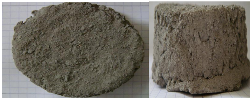
Figure V-36 : Echantillon 1 marne 2 après le 4 em cycle.
