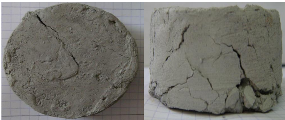
Figure V-22 : Echantillon 1 marne 1 après le 1 er cycle.
