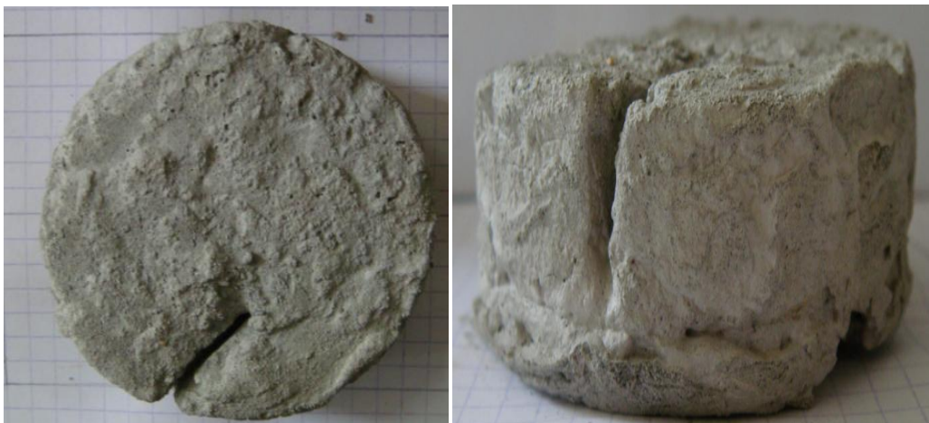
Figure V-35 : Echantillon 2 marne 1 après le 4 em cycle.
