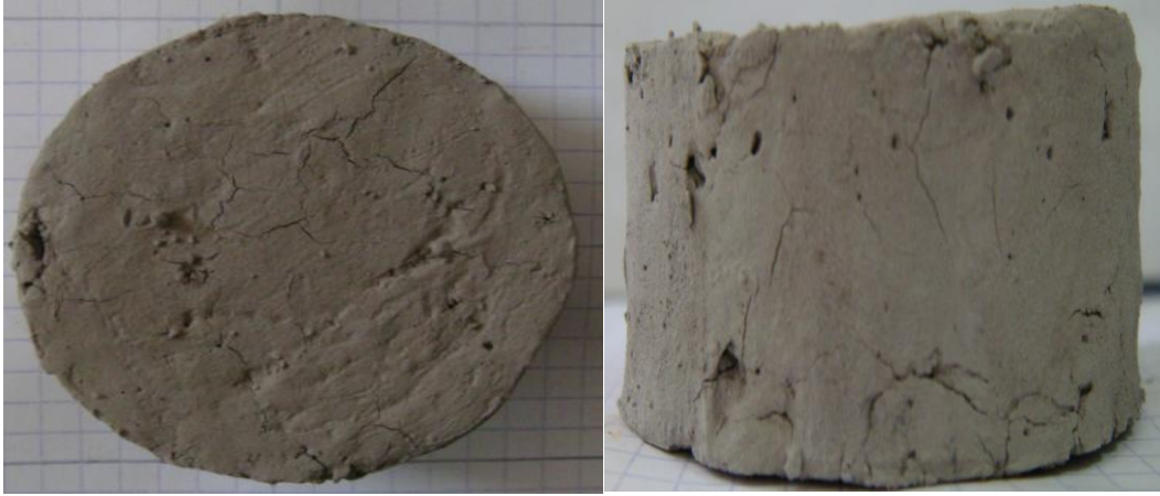
Figure V-24: Echantillon 1 marne 2 après le 1 er cycle.
