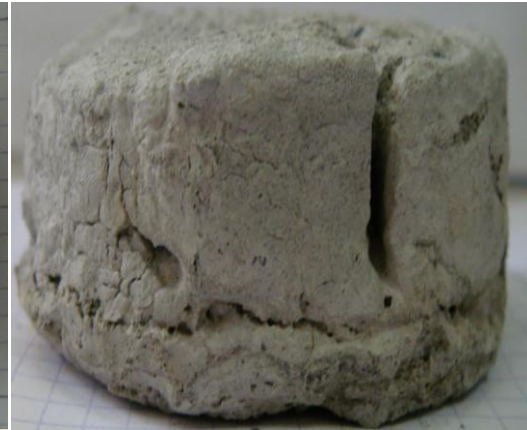
Figure V-30 : Echantillon 1 marne 1 après le 3 em cycle.
