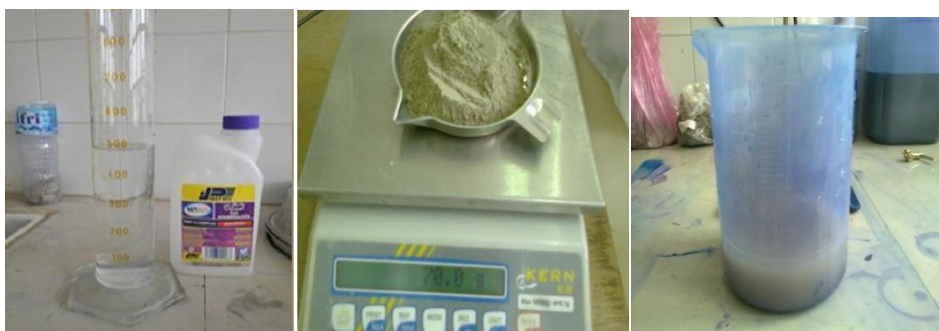
Figure IV-11: Matériel d'essai au bleu de méthylène –Essai à la tâche.
