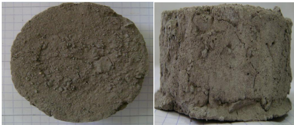
Figure V-29 : Echantillon 2 marne 2 après le 2 em cycle.
