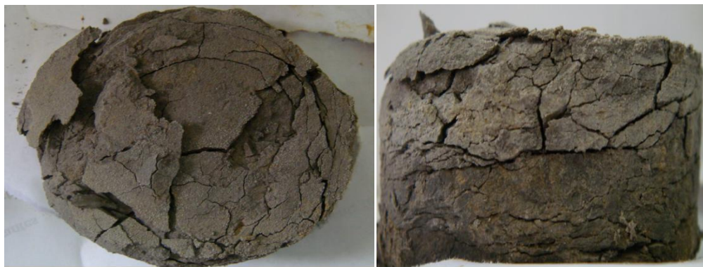
Figure V-14 : Echantillon 1 de la marne 2 à la fin de l'essai gel/dégel.
