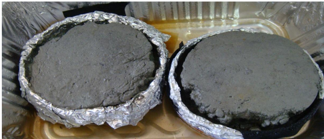
Figure V-11 : Marne 1 après 5 cycles de gel/dégel.
