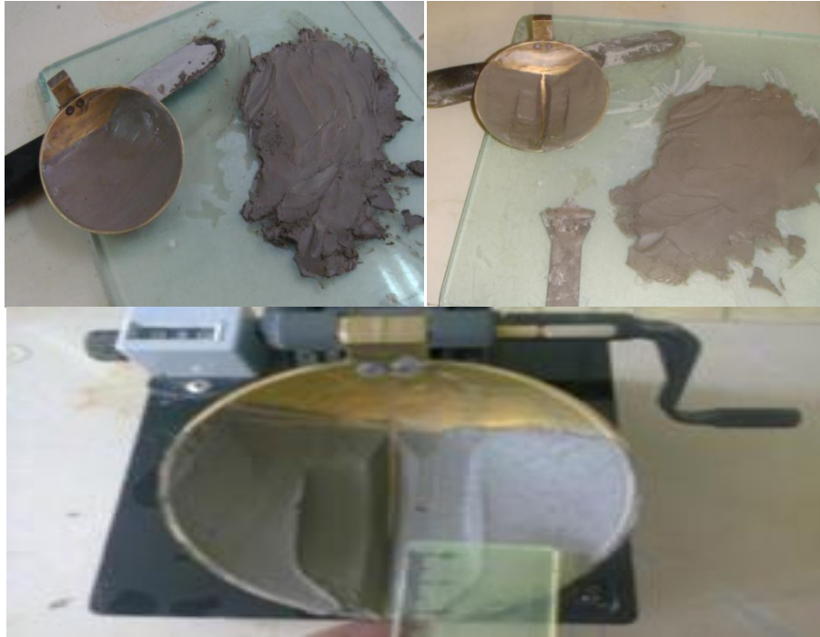
Figure IV-6: Détermination de la limite de liquidité.
