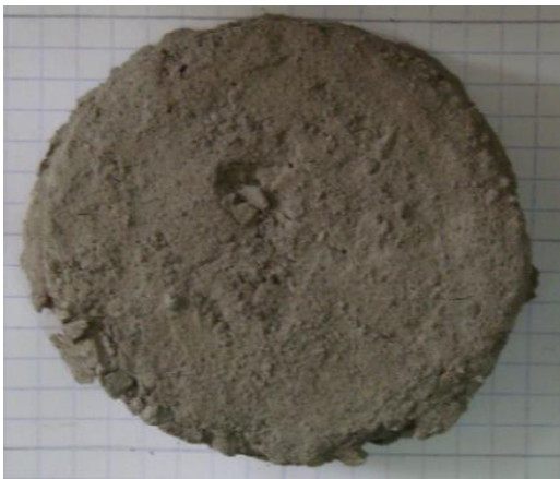
Figure V-32 : Echantillon 1 marne 2 après le 3 em cycle.
