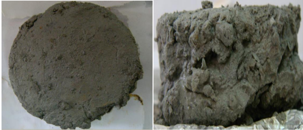
Figure V-13 : Echantillon 2 de la marne 1 à la fin de l'essai gel/dégel.
