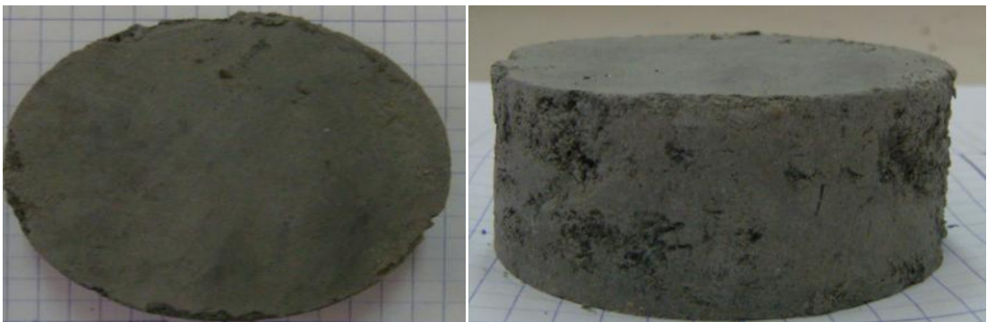
Figure V-5 : Echantillon 2 de la marne 1 avant l'étuvage.
