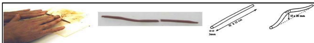
Figure IV-10: Etapes de la limite de plasticité.
