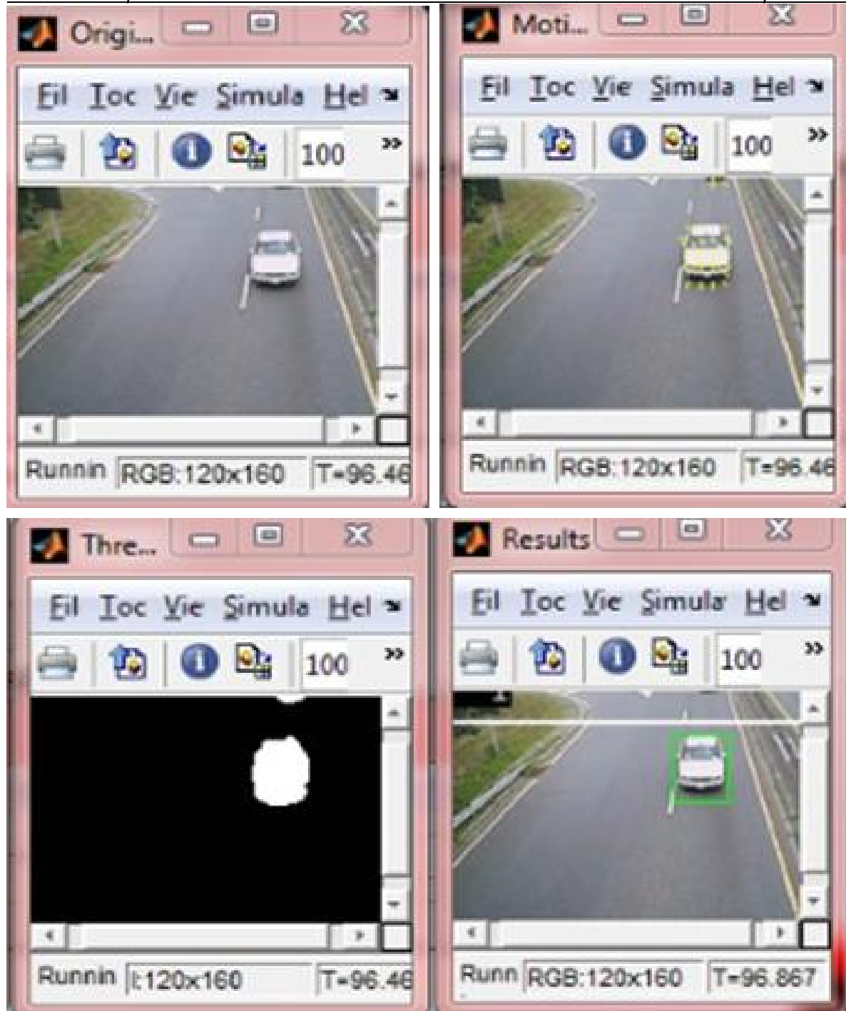
Fig3.4 le résultat de la méthode de HS appliqué sur la vidéo viptraffic.
