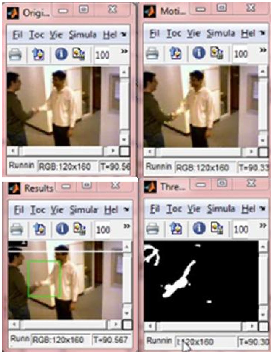
Fig.3.3 le résultat de la méthode de HS appliqué sur la vidéo vipmen.
