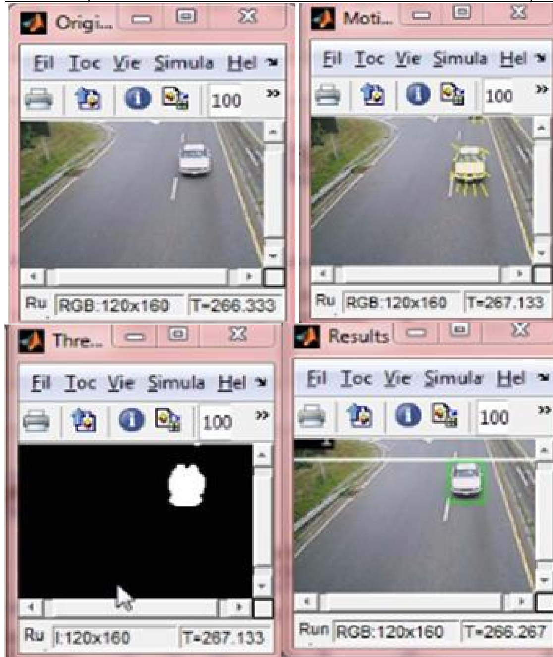
Fig.3.8 le résultat de la méthode de LK appliqué sur la vidéo viptraffic.
