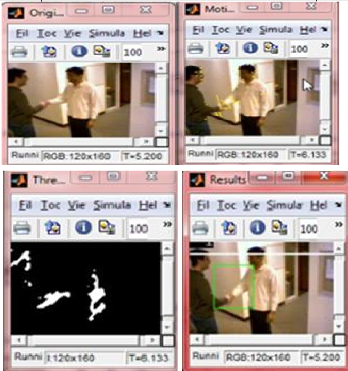
Fig. 3.7 le résultat de la méthode de LK appliqué sur la vidéo vipmen.
