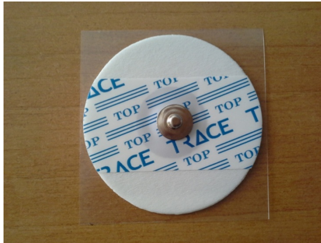
Figure .III.2. Electrode finalement utilisée de 50mm de diamètre
