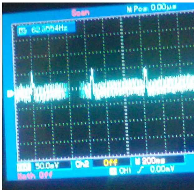
Figure. IV.15. Signal à la sortie de l'AD620
