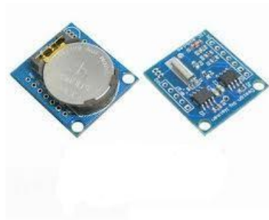
Figure.III.9. L'horloge temps réel [51]
