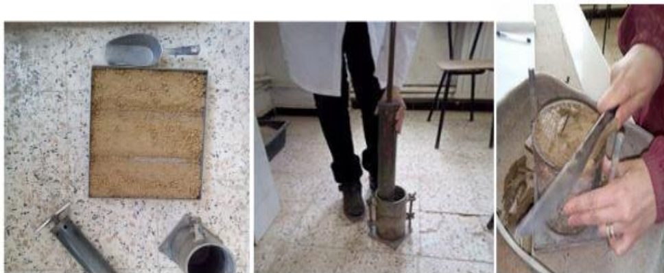
Figure V.11. Déroulement de l'essai Proctor normal.
