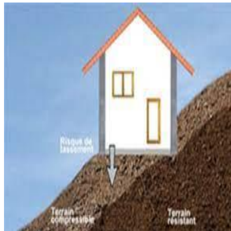
Figure I.25. Phénomène du tassement
