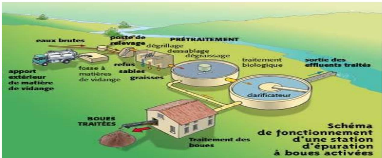
Figure (I .2) : Schéma de fonctionnement d'une station d'épuration à boues activées .
