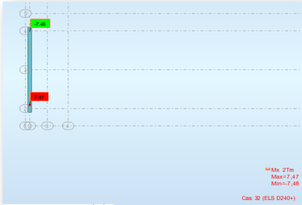
Figure VII. 10: Moment maximum longitudinal dans la poutre(entretoise).
