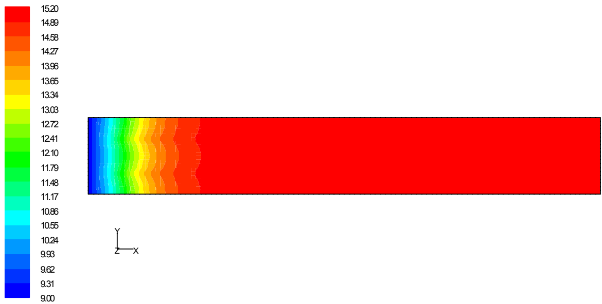
Fig.III.31 Distribution de l'humidité absolue [kg eau /kg as ] le long de la conduite à t= 5s.
