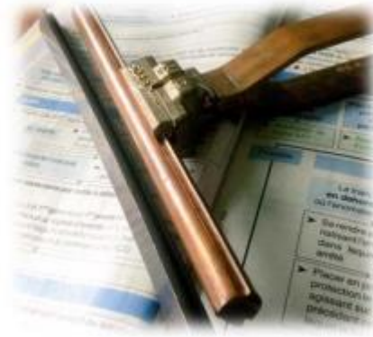
Figure25 : Fil de contact 107mm 2 rainures pour caténaire 1x25Kv
