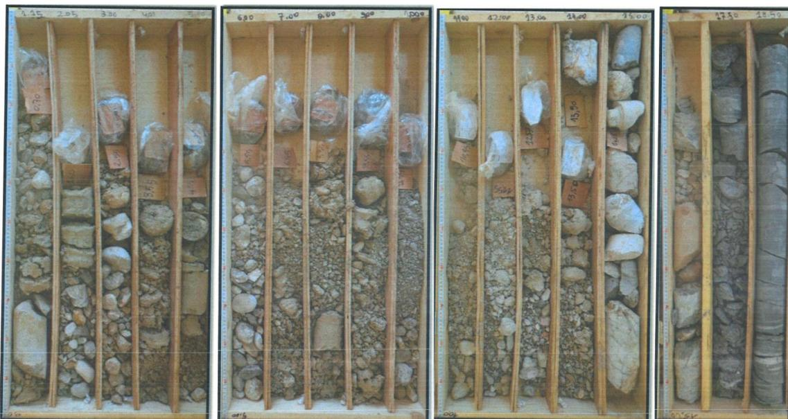
Photographie 8 : Photo des caisses des sondages carottés dans les alluvions jusqu'au substratum schisteux.
