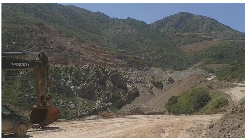
Photographie 4 : Vue de la Carrière de Keddara (Boumerdes) : exploitation des calcaires du Jurassique et de l'Eocène en gradins de 10 à 15 m.(24/05/2018 à 11:30)
