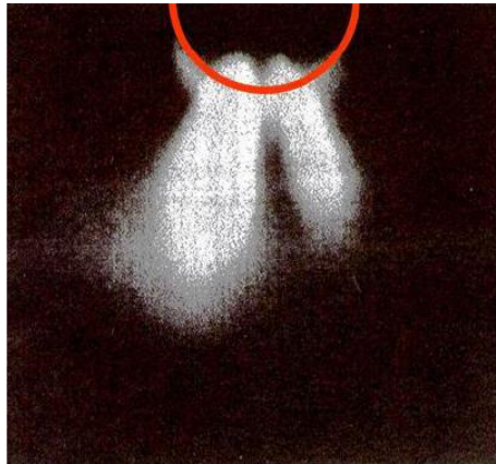
Figure II.9 Photographie de la décharge couronne positive à courant impulsionnel ( R_p = 1 cm, V = 126 kV) [Du-1, Na-2].
