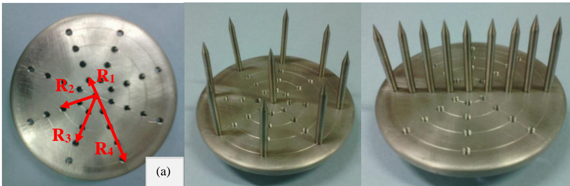
Figure V.2 Système multi-pointes utilisé : (a) Distance R des pointes par rapport à la pointe centrale, avec R_1 = 1\text{ cm} , R_2 = 2\text{ cm} , R_3 = 3\text{ cm} , R_4 = 4\text{ cm} . (b) disposition circulaire pour R = R_4 = 4\text{ cm} , (c) disposition en peigne.
