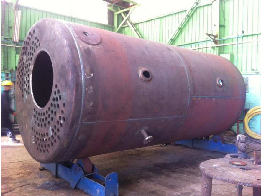
Figure II.8 : Virole avec plaques tubulaires et piquages.
