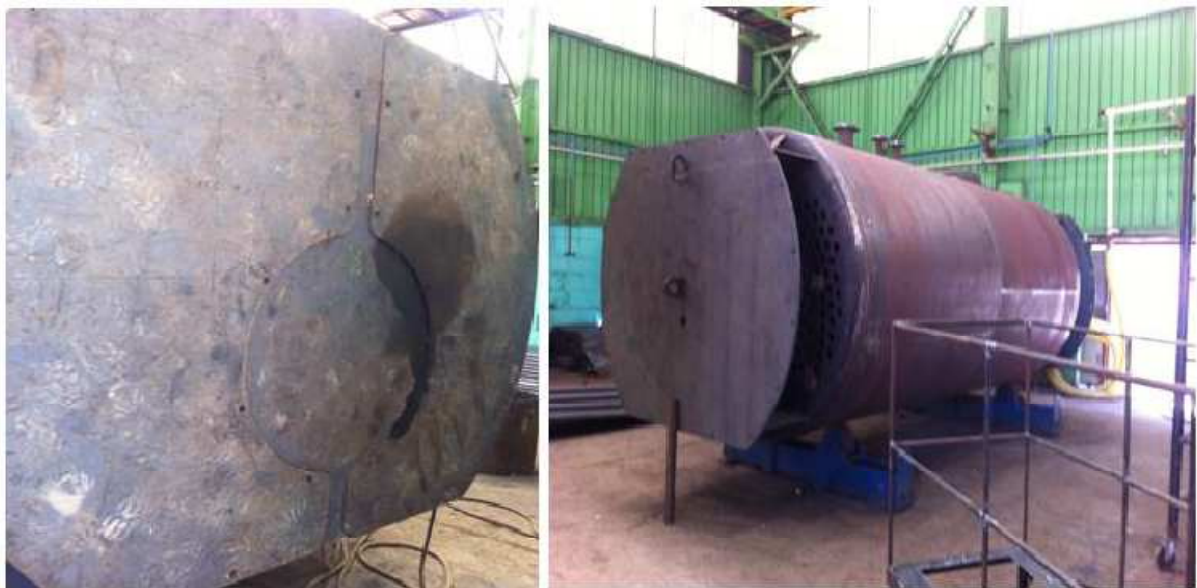
Figure II.10 : Boîte de retour, foyer et portes montés
