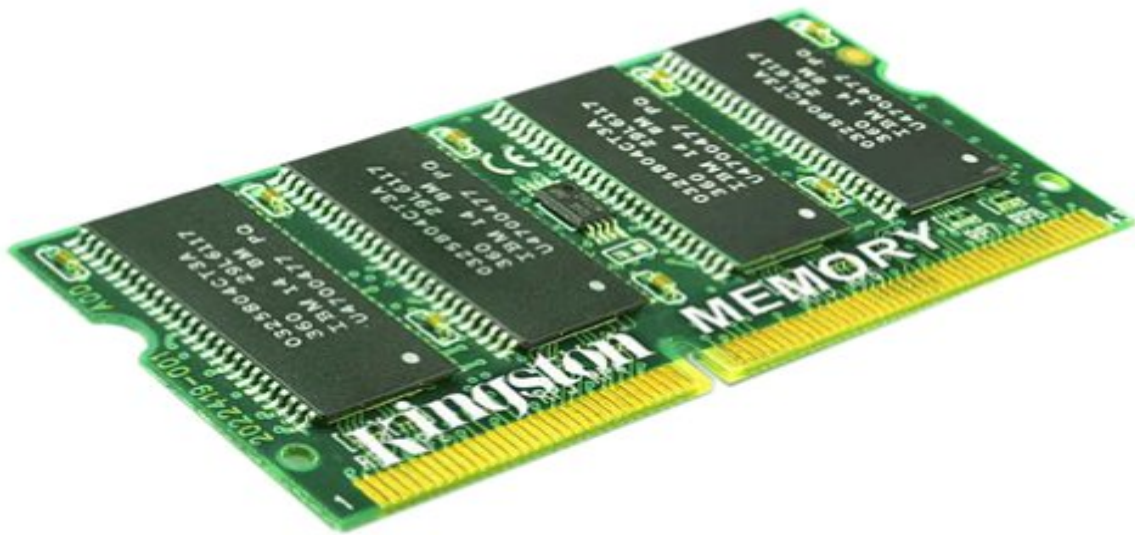
Figure I.6 : une mémoire Ram d'un PC
