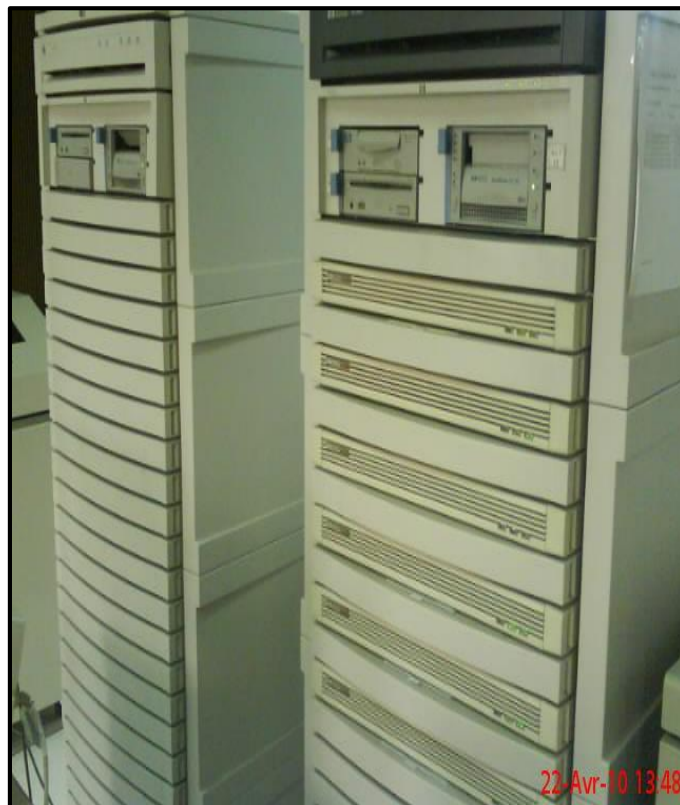
Figure III.4 : La face avant de serveur HP3000/A500.
