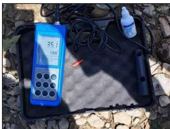
Figure 10: Oxymètre pour la mesure de la température et de l'oxygène dissous
