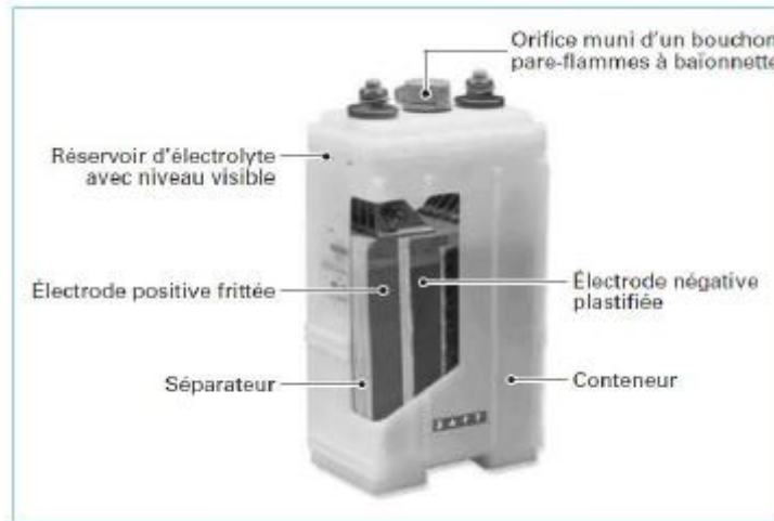
Figure 16 : Vue éclatée d'une batterie nickel-cadmium Ni-Cd industrielle [34].
