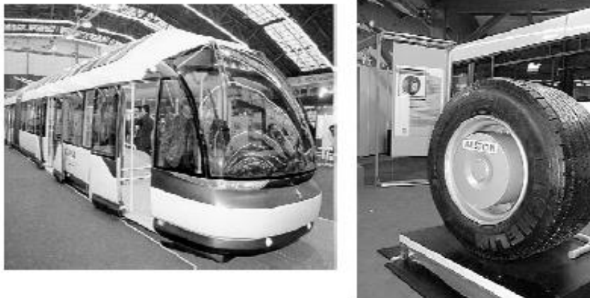
Figure 4 : Exemple de 'moteur hub' réalisé par la société Alstom Transport pour la traction d'un Tramway. [20]
